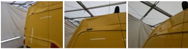
3ème feu stop, Cassé, E - Remplacer
