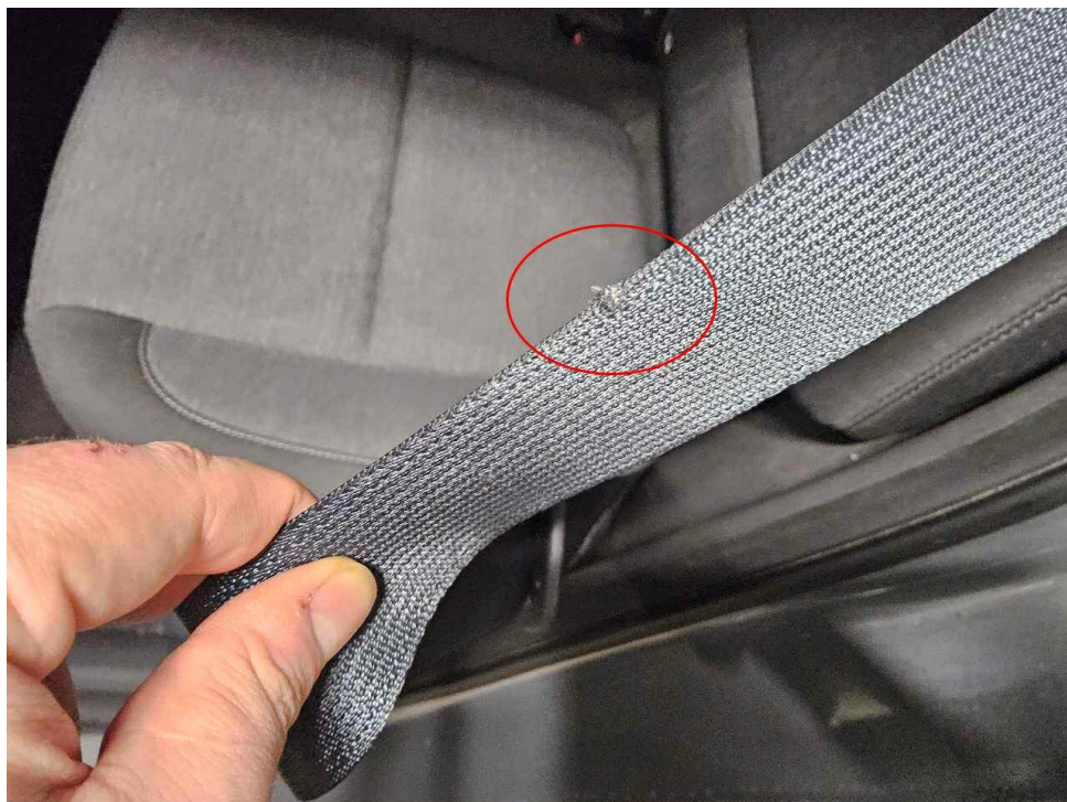
Bild 10 : Sicherheitsgurt hinten links beschädigt
