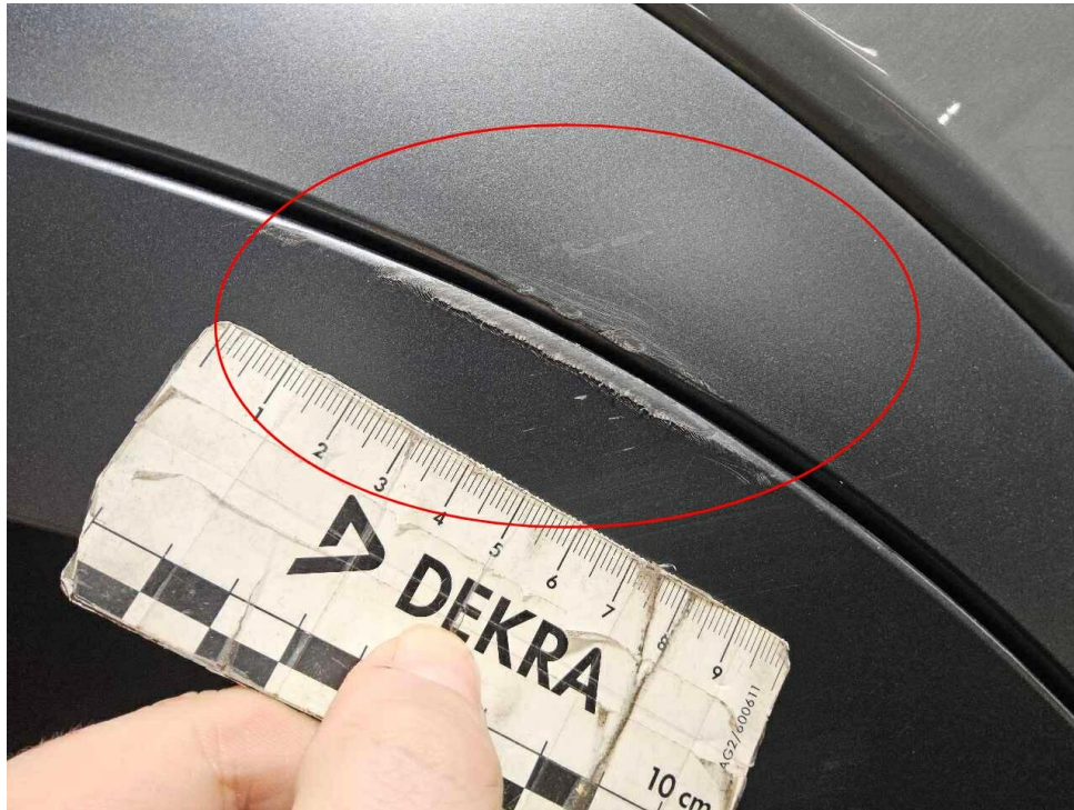
Bild 11 : Radhausverbreiterung hinten links verschrammt
