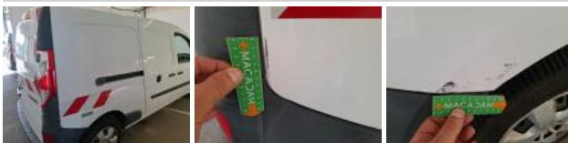
Pare-chocs AR, Déformé / Forcé, Acceptable
