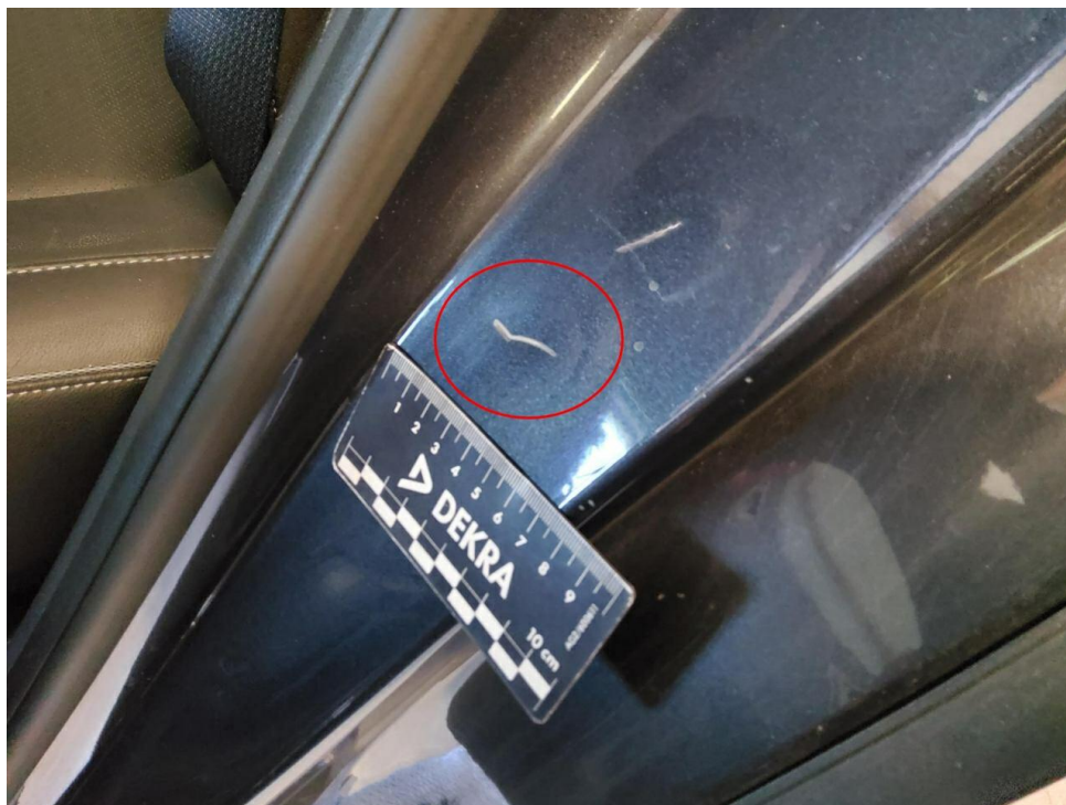
Bild 9 : Tür hinten links Einstieg, eingedellt und verschrammt , smart repair
