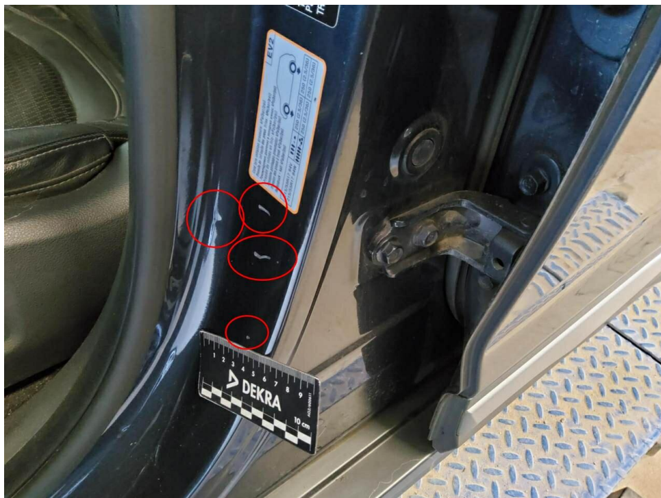
Bild 10 : Tür vorne links Einstieg, eingedellt und verschrammt , smart repair
