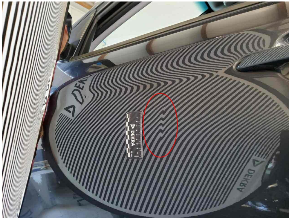
Bild 7 : Tür vorne links, eingedellt, smart repair
