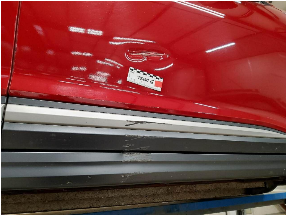
Bild 11 : Seitenschaden rechts gem.Kalkulation
