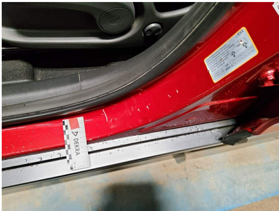
Bild 6 : Einstieg vorne links Kratzer
