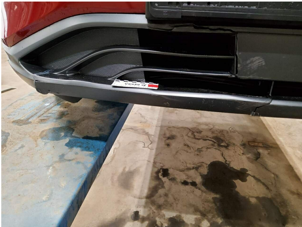
Bild 12 : Frontschaden gem. kalkulation
