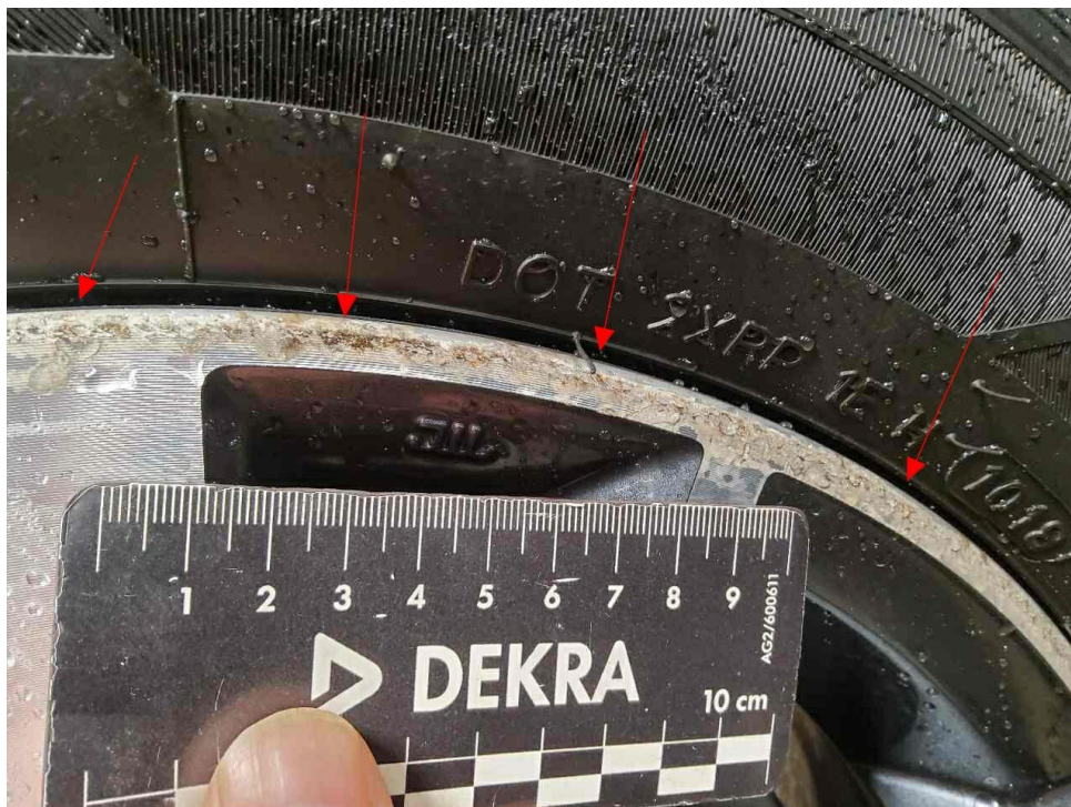
Bild 10 : Felge vorne rechts starker Materialabtrag
