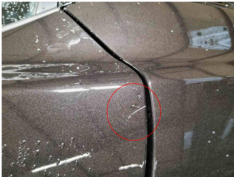
Bild 6 : Tür hinten links Lackierung, zerkratzt, Gebrauchsspur
