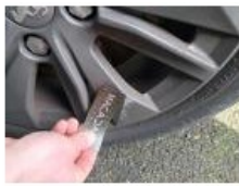
Pneu AVG, Déchirure, E - Remplacer
