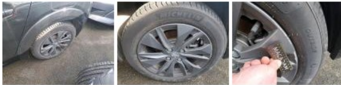
Pneu ARG, Déchirure, E - Remplacer
