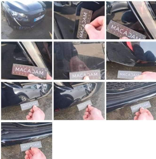
Grille de pare-chocs AVM, Cassé, E - Remplacer
