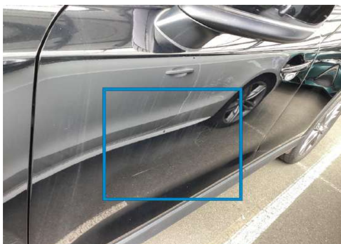
3. Porte Avant Gauche Peinture Rayure Ligne -
