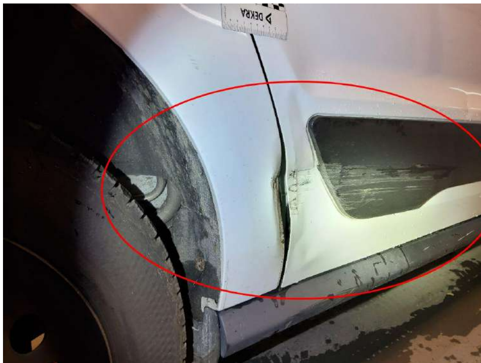
Bild 29 : Streifschaden rechts (Schiebetür und Seitenwand), inst.gem.Kalkulation
