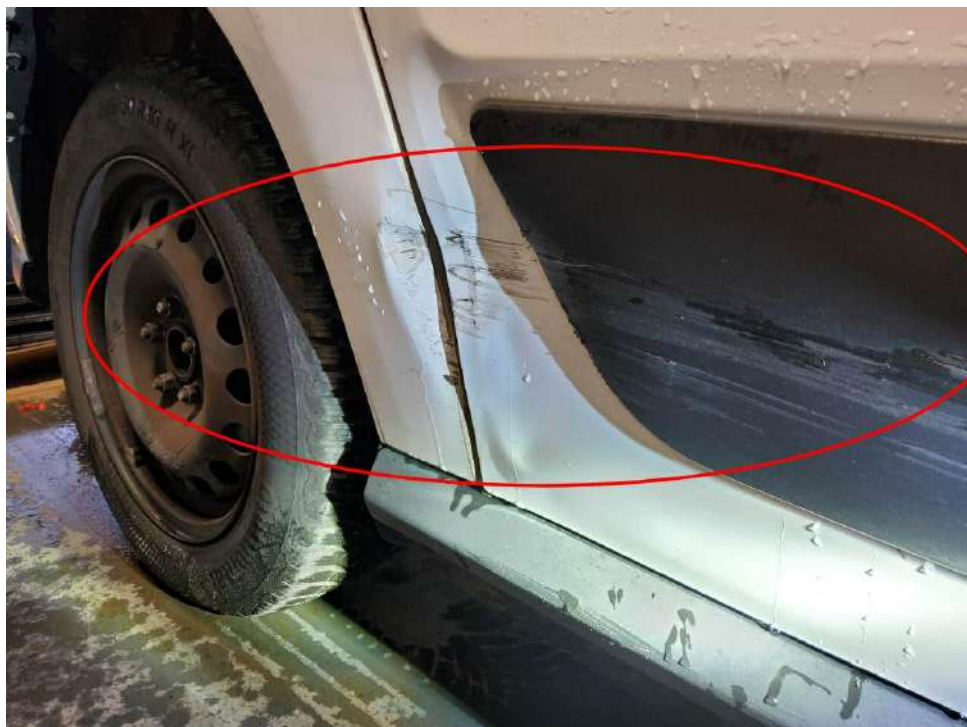
Bild 28 : Streifschaden rechts (Schiebetür und Seitenwand), inst.gem.Kalkulation
