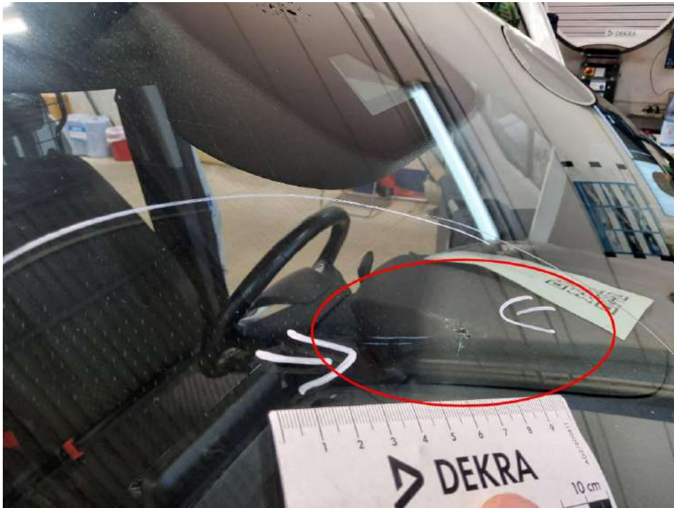
Bild 13 : Frontscheibe, Steinschlag mit Riss
