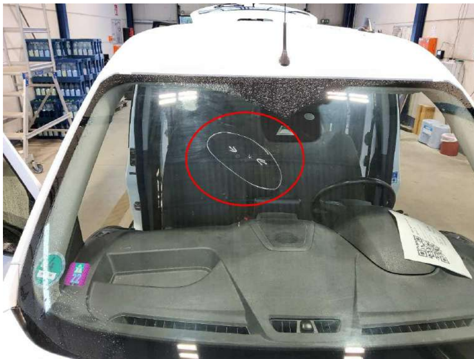
Bild 12 : Frontscheibe, Steinschlag mit Riss
