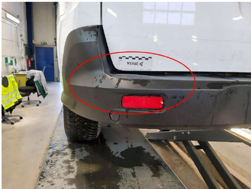
Bild 24 : Stoßfänger hinten, verformt
