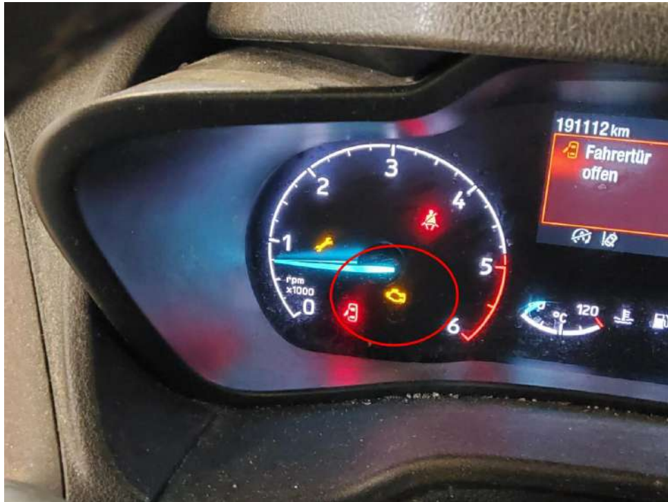
Bild 15 : Motorkontrollleuchte aktiv und Ölverlust, inst.gem.KVA
