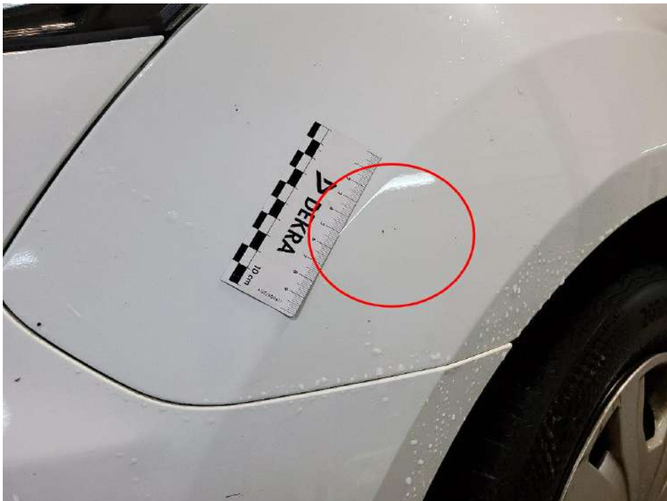
Bild 32 : Kotflügel vorne links, Steinschlag, Gebrauchsspur
