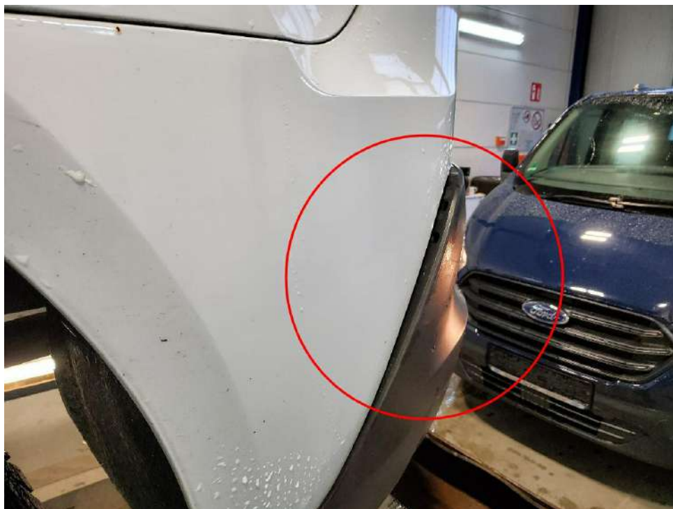
Bild 25 : Stoßfänger hinten, verformt
