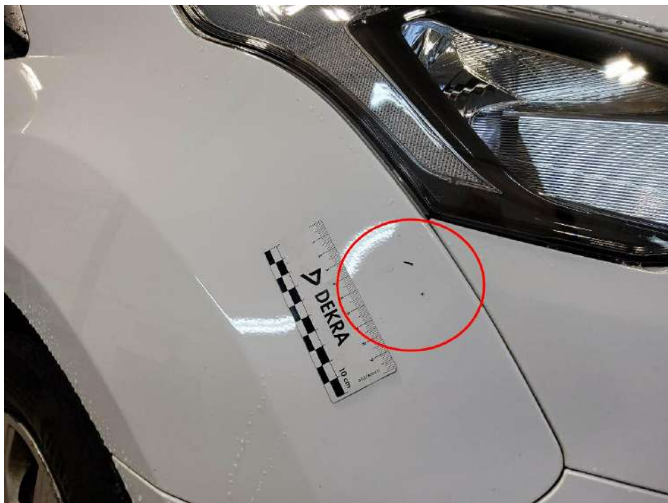
Bild 30 : Kotflügel vorne rechts, Steinschlag, Gebrauchsspur
