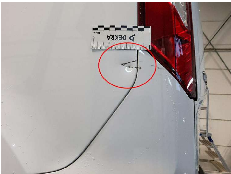
Bild 26 : Seitenwand links, eingedellt und verschrammt
