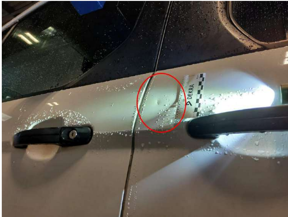
Bild 23 : Schiebetür links, mehrfach eingedellt
