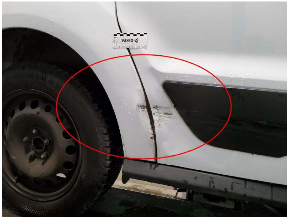
Bild 27 : Streifschaden rechts (Schiebetür und Seitenwand), inst.gem.Kalkulation
