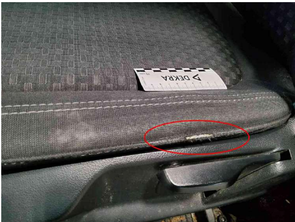
Bild 14 : Sitz vorne links, Bezug beschädigt
