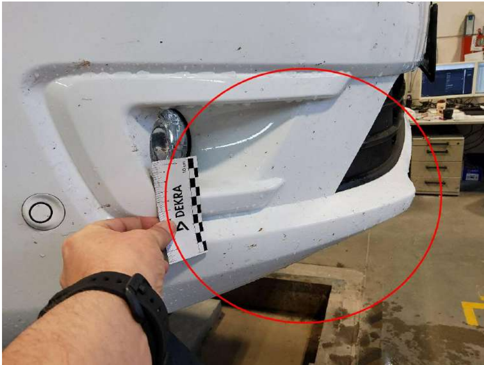
Bild 31 : Stoßfänger vorne Lackierung, viele Steinschläge, lackieren
