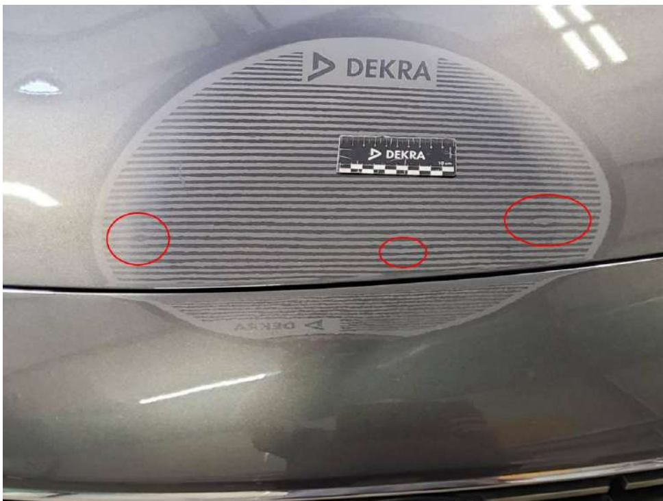
Bild 20 : Motorhaube, mehrfach eingedellt, instandsetzen und lackieren mit Lackaufbau
