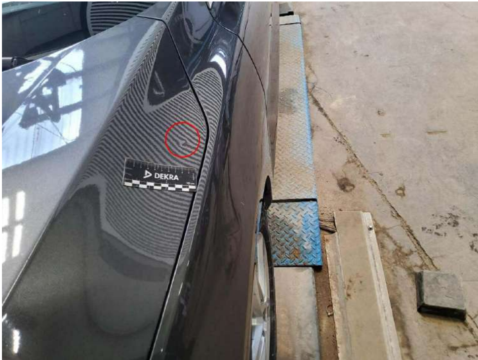
Bild 19 : Motorhaube, mehrfach eingedellt, instandsetzen und lackieren mit Lackaufbau
