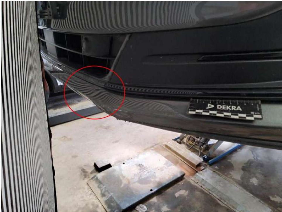
Bild 15 : Stoßfänger vorne, eingedellt, verschrammt , instandsetzen und lackieren mit Lackaufbau
