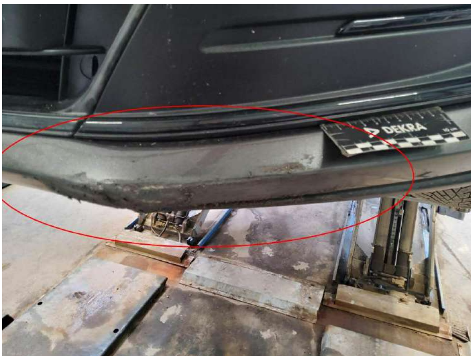
Bild 16 : Stoßfänger vorne, eingedellt, verschrammt , instandsetzen und lackieren mit Lackaufbau
