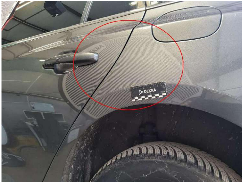
Bild 9 : Seitenteil hinten links Lackierung, nicht fachgerecht, wellig , lackieren mit Lackaufbau
