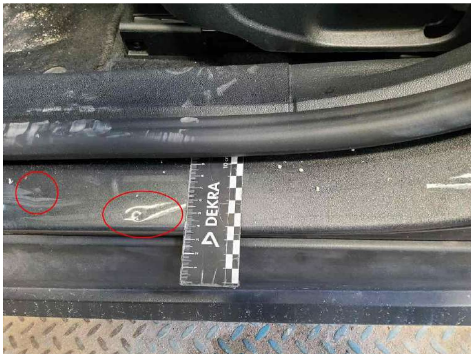
Bild 22 : Einstieg vorne links eingedellt
