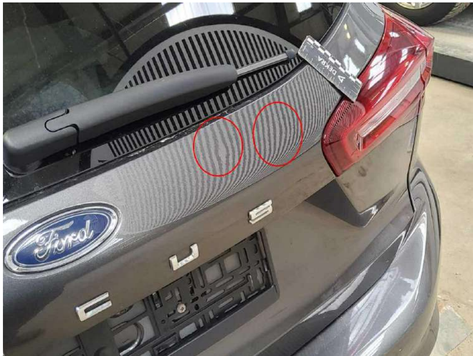
Bild 17 : Heckklappe, mehrfach eingedellt, instandsetzen und lackieren mit Lackaufbau
