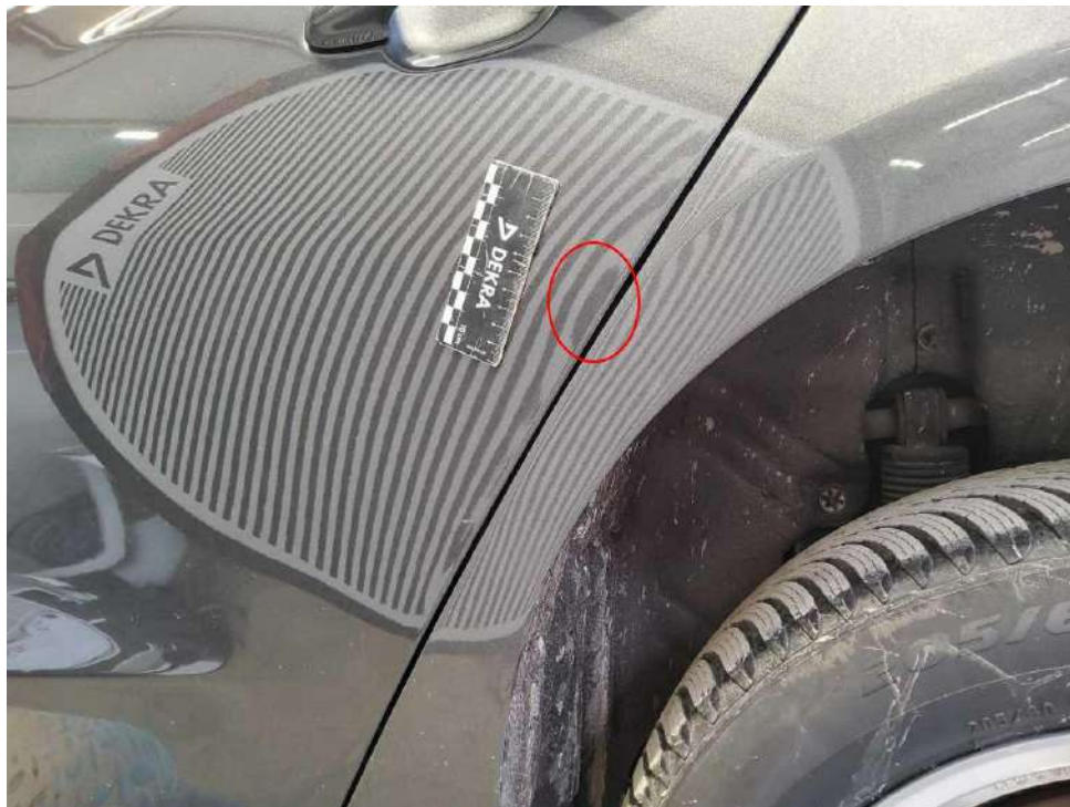
Bild 8 : Tür hinten links, eingedellt, smart repair
