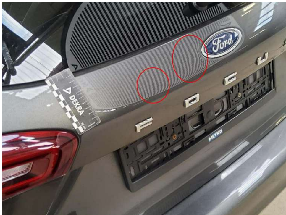
Bild 18 : Heckklappe, mehrfach eingedellt, instandsetzen und lackieren mit Lackaufbau
