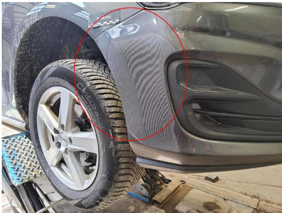
Bild 14 : Stoßfänger vorne, eingedellt, verschrammt , instandsetzen und lackieren mit Lackaufbau
