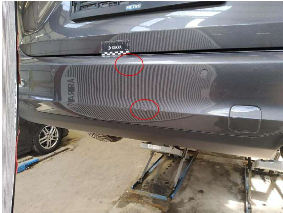
Bild 11 : Stoßfänger hinten, eingedellt, verschrammt , instandsetzen und lackieren mit Lackaufbau
