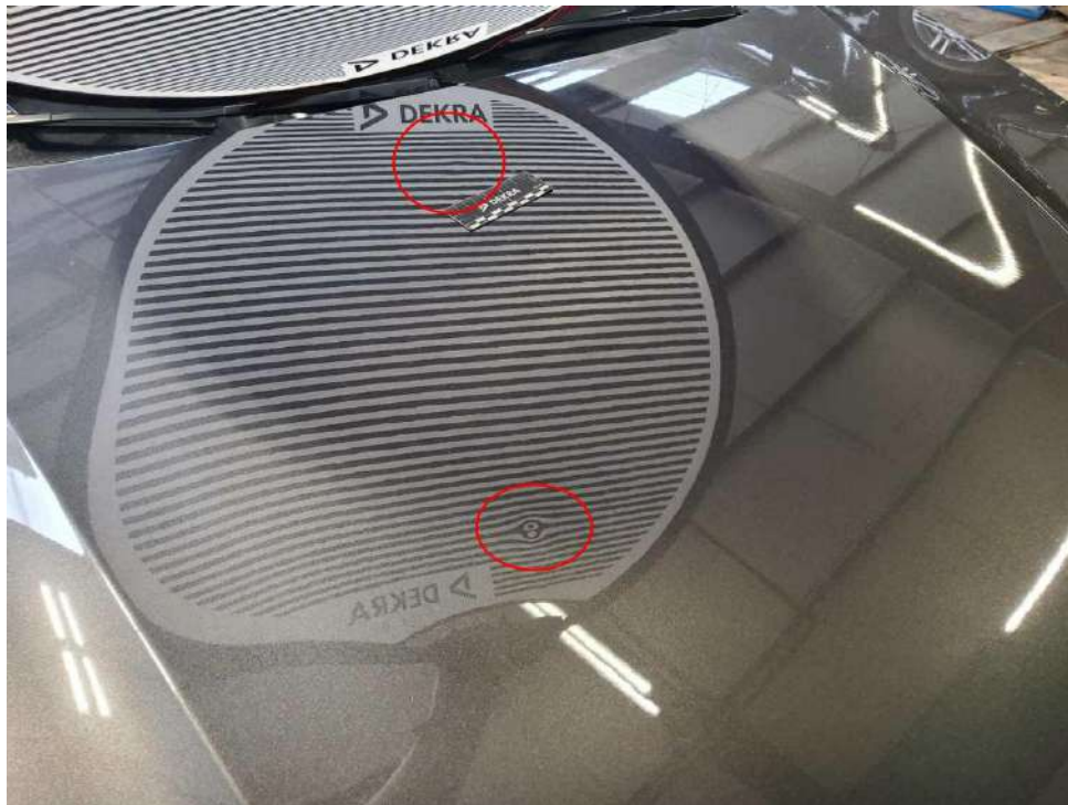
Bild 21 : Motorhaube, mehrfach eingedellt, instandsetzen und lackieren mit Lackaufbau
