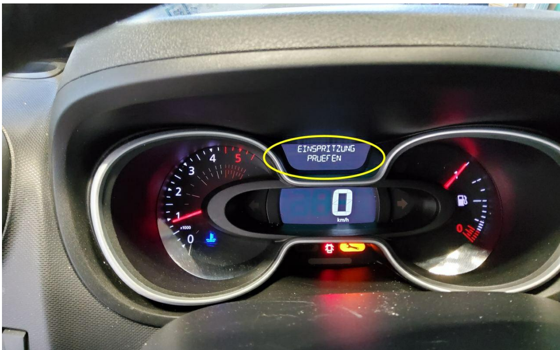
Bild 10 : Einspritzung Fehler lt. Anzeige, Turbolader gem KVA erneuern
