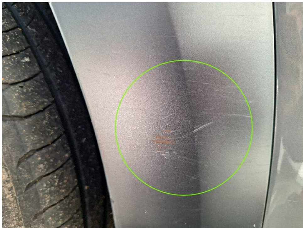
Bild 20 : Radhausverbreiterung vorne rechts zerkratzt
