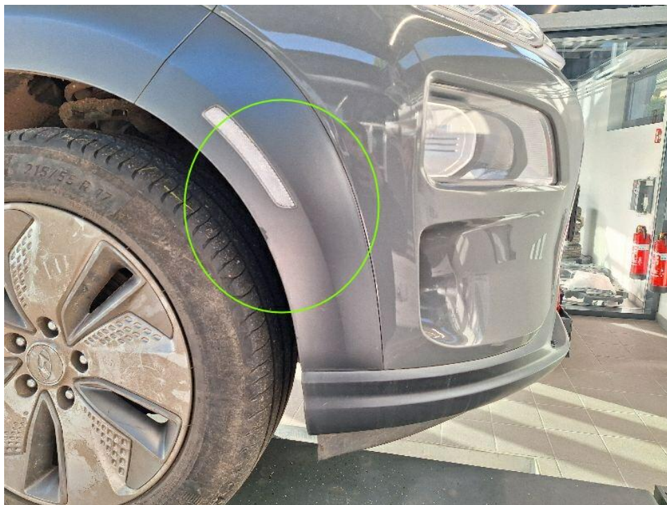
Bild 19 : Radhausverbreiterung vorne rechts zerkratzt
