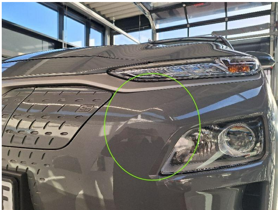
Bild 14 : Stoßfänger vorne zerkratzt
