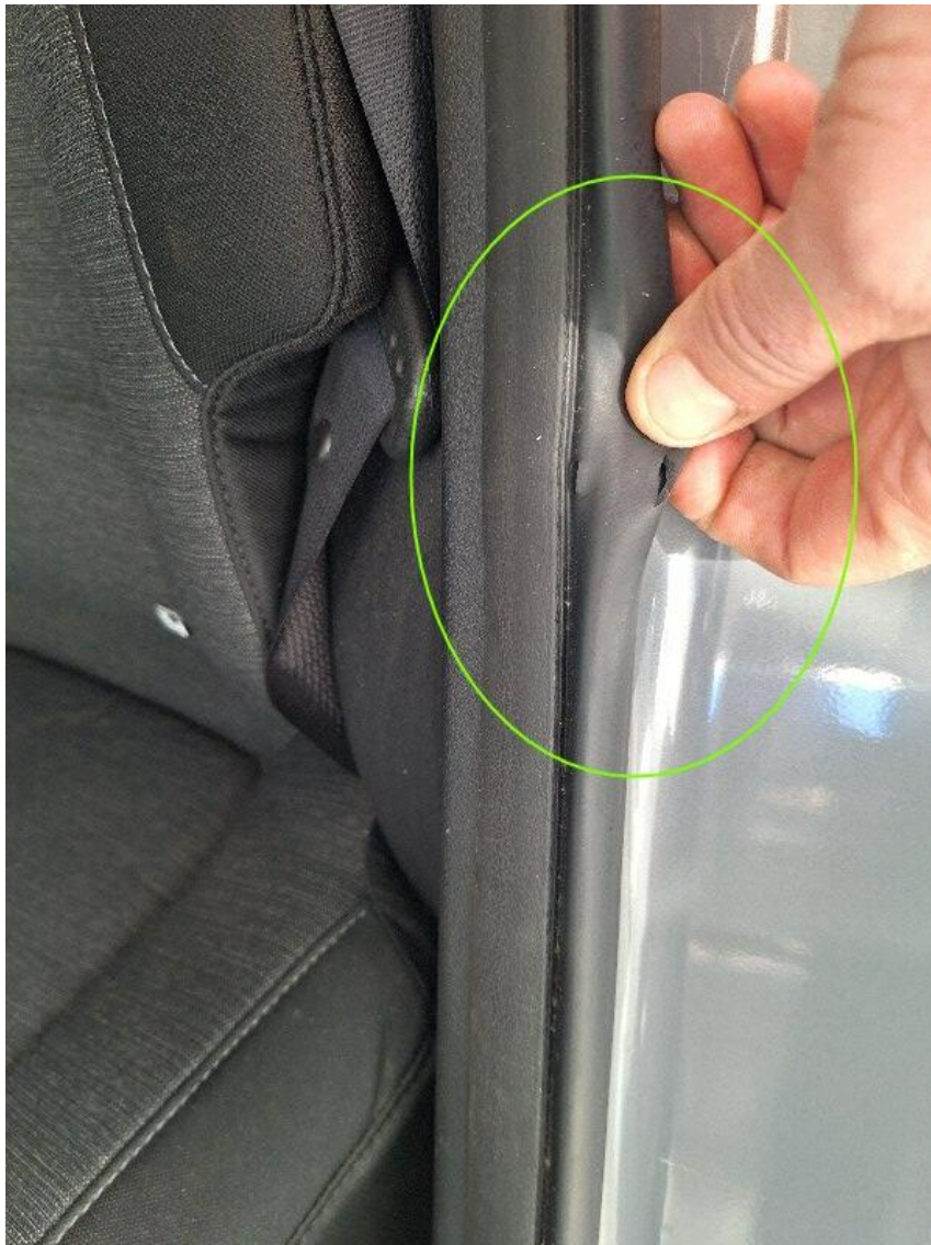
Bild 6 : Dichtung Einstieg hinten links eingerissen
