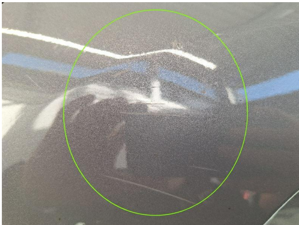
Bild 15 : Stoßfänger vorne zerkratzt
