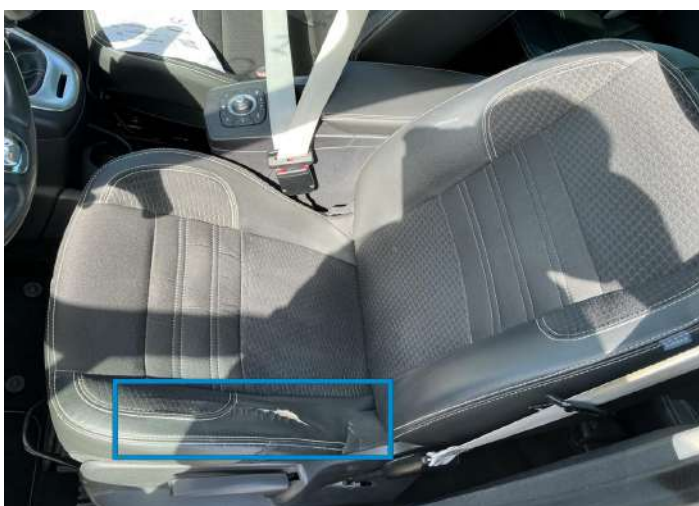
15. Siège Avant Gauche Déchiré -
