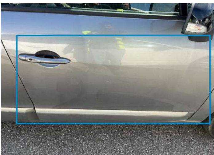
2. Porte Avant Droite Peinture Rayure Ligne -
