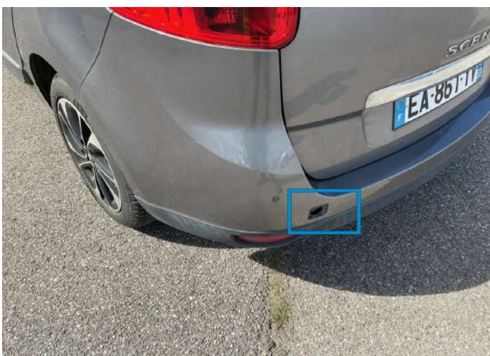
16. Échappement Arrière Gauche Absence de l'élément -
