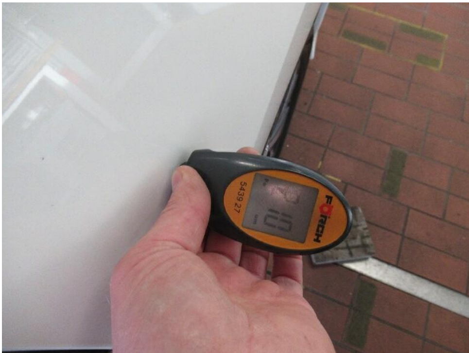
Bild 14 : Kotflügel vorne rechts, nachlackiert
