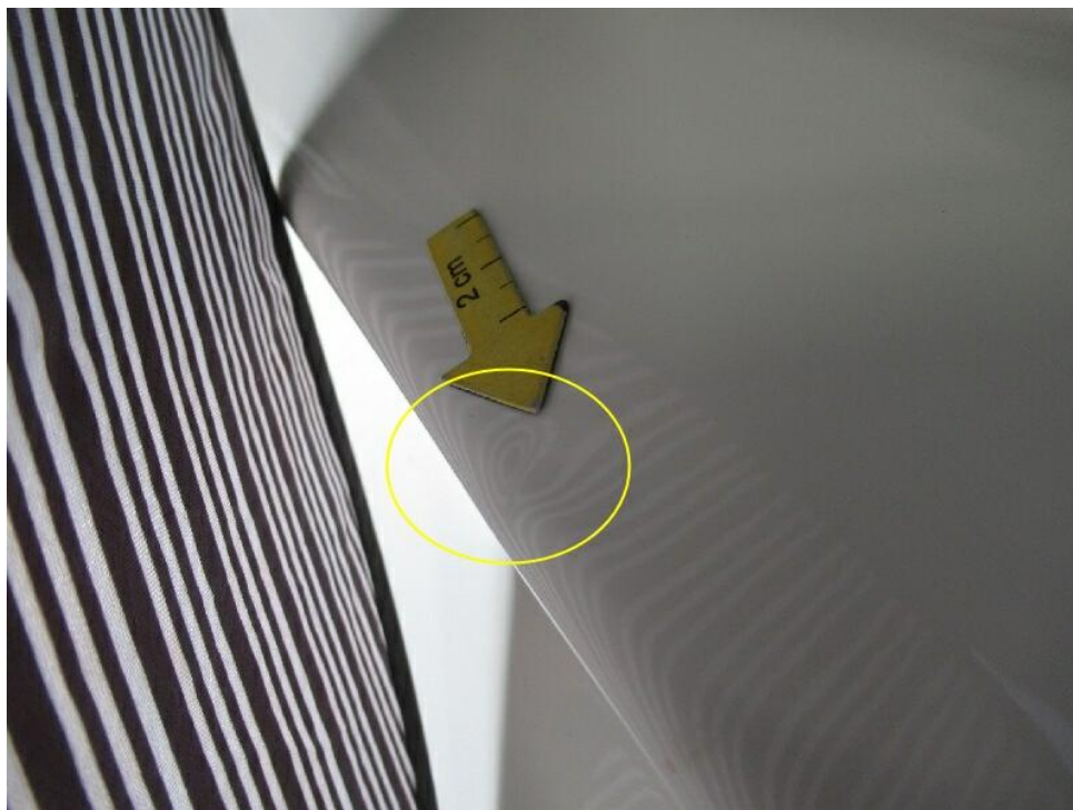
Bild 9 : Tür hinten links Einstieg, mehrfach egedellt,
