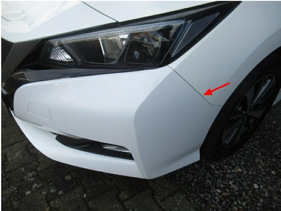
Bild 7 : Stoßfänger vorne Lackierung, nicht fachgerecht, lackieren mit Lackaufbau deutlicher Farbunterschied
