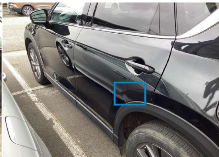
14. Door / Back Left Bodywork / Dent / Dent -
