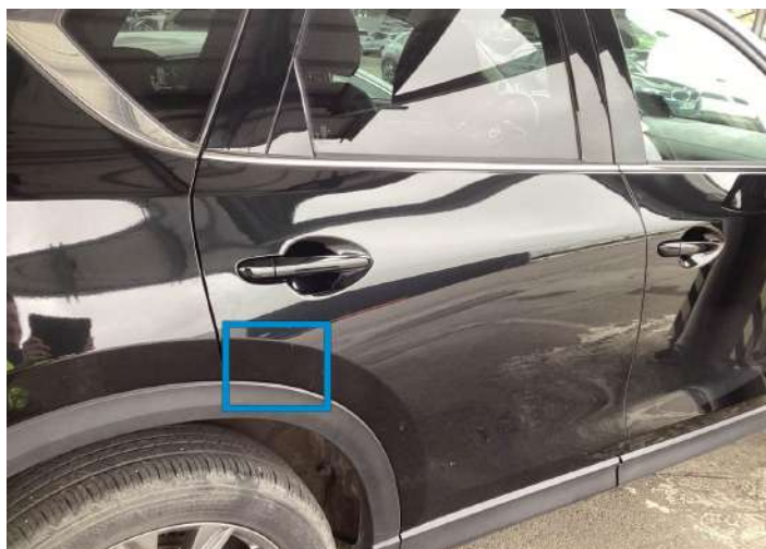
13. Door / Back Right Paint / Chipping -
