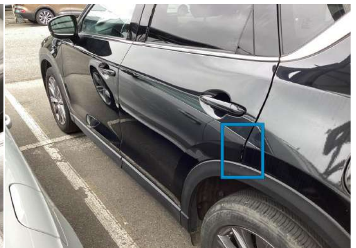
12. Door / Back Left Paint / Chipping -
