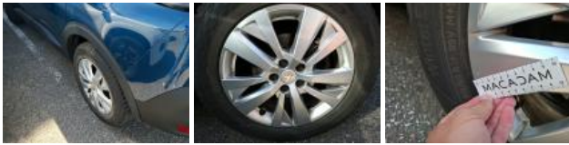
Alloy rim RL, Scratch(es), Repair/replace (lump sum)
