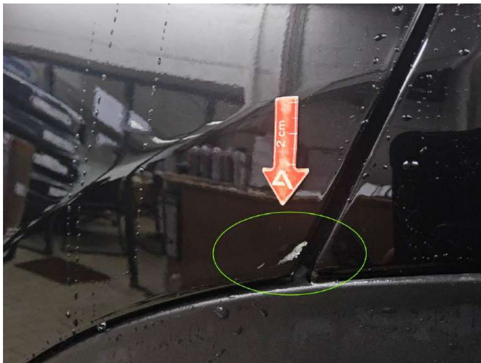
Bild 21 : Tür hinten links Lackierung, zerkratzt, smart repair Eindringtiefe bis zum Metallgrund
