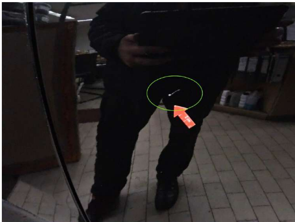
Bild 19 : Tür vorne links Lackierung, zerkratzt, auslegen und polieren Eindringtiefe bis Grundierung
