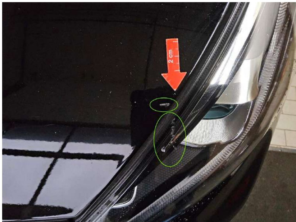
Bild 16 : Motorhaube Lackierung, zerkratzt, Gebrauchsspur Scheinwerfer links Glas, zerkratzt, Gebrauchsspur
