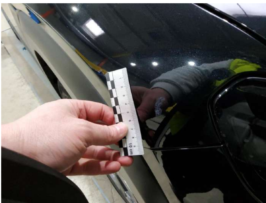
Bild 36 Fahrzeug aussen Lackbeschädigung - Aufbereiten
