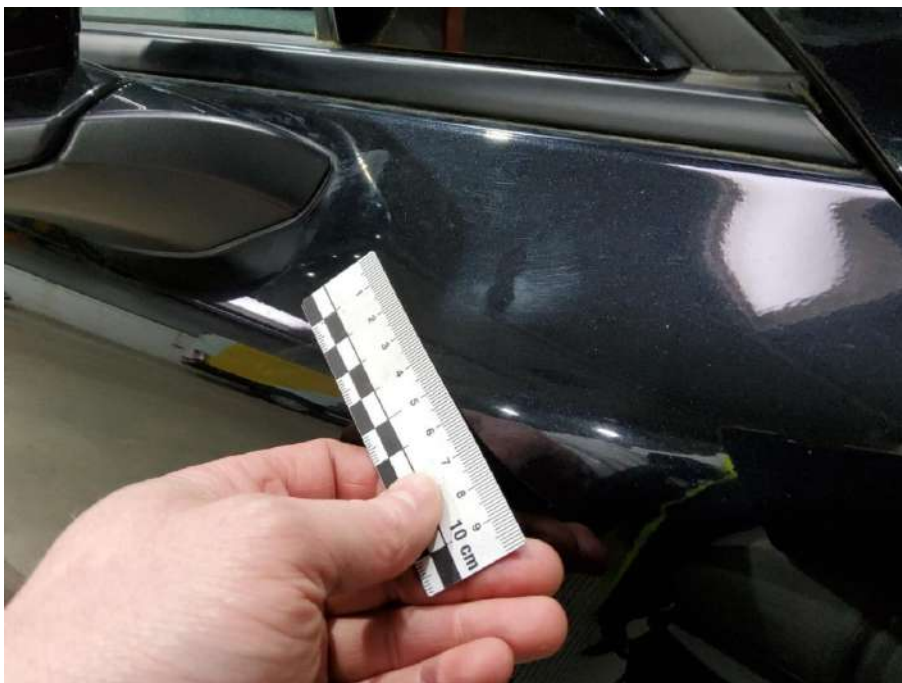
Bild 37 Fahrzeug aussen Lackbeschädigung - Aufbereiten
