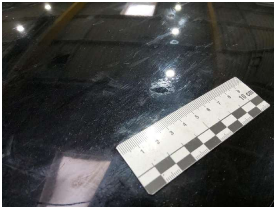
Bild 29 Dach Delle mit Lackbeschäd. - Instandsetzen
