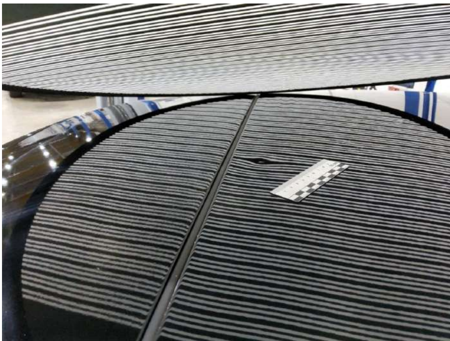
Bild 27 Dach Delle mit Lackbeschäd. - Instandsetzen
