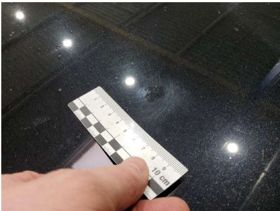
Bild 33 Fahrzeug aussen Lackbeschädigung - Aufbereiten
