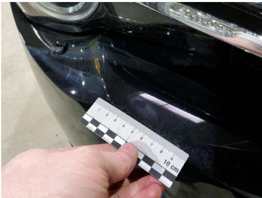
Bild 35 Fahrzeug aussen Lackbeschädigung - Aufbereiten
