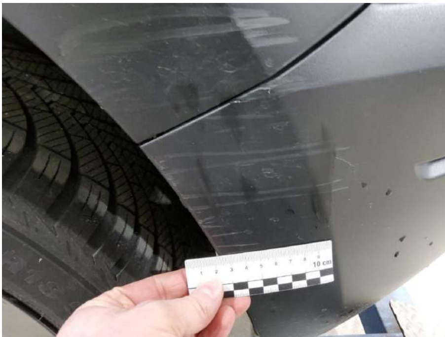
Bild 20 Stoßfänger hinten Verschrammt - Erneuern
