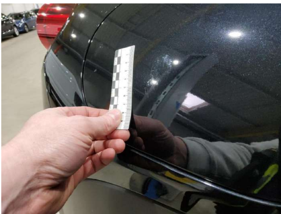
Bild 38 Fahrzeug aussen Lackbeschädigung - Aufbereiten
