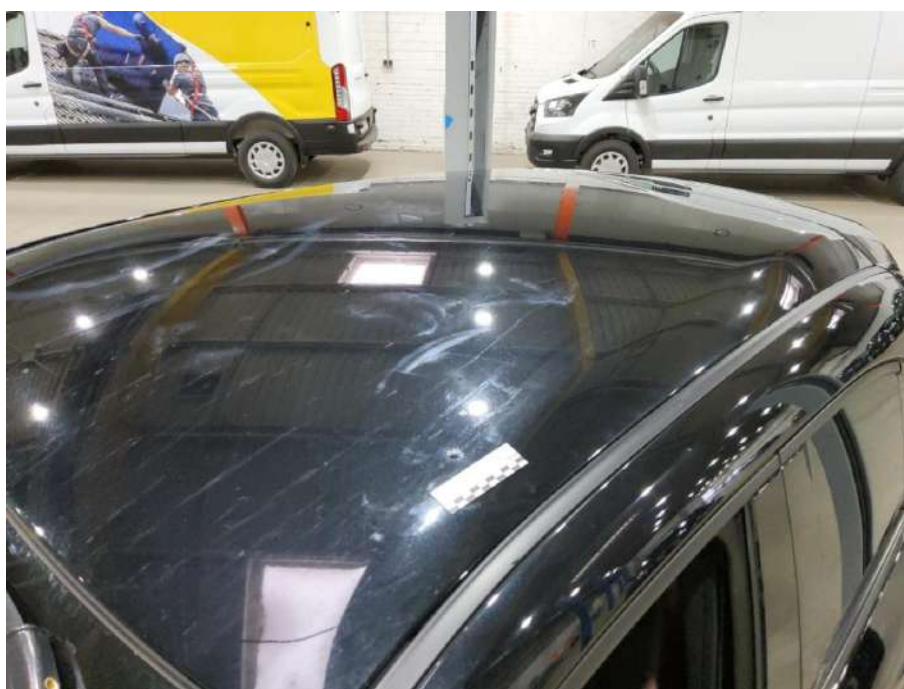
Bild 30 Dach Delle mit Lackbeschäd. - Instandsetzen
