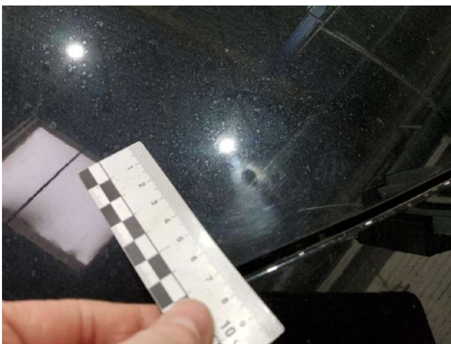
Bild 32 Fahrzeug aussen Lackbeschädigung - Aufbereiten
