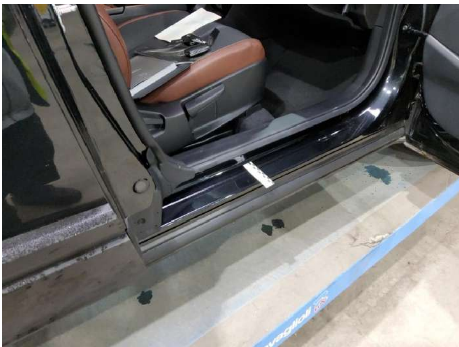
Bild 23 Türeinstieg vorne rechts Delle - Smart repair
