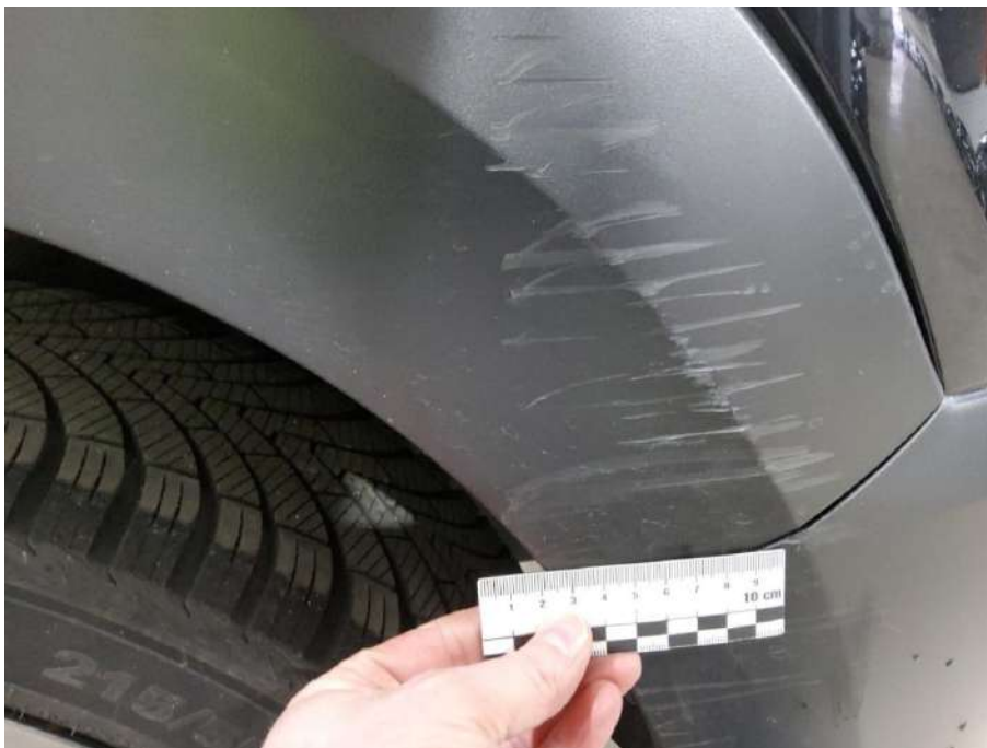
Bild 18 Kotflügelverbreiterung hinten links Verschrammt - Erneuern
