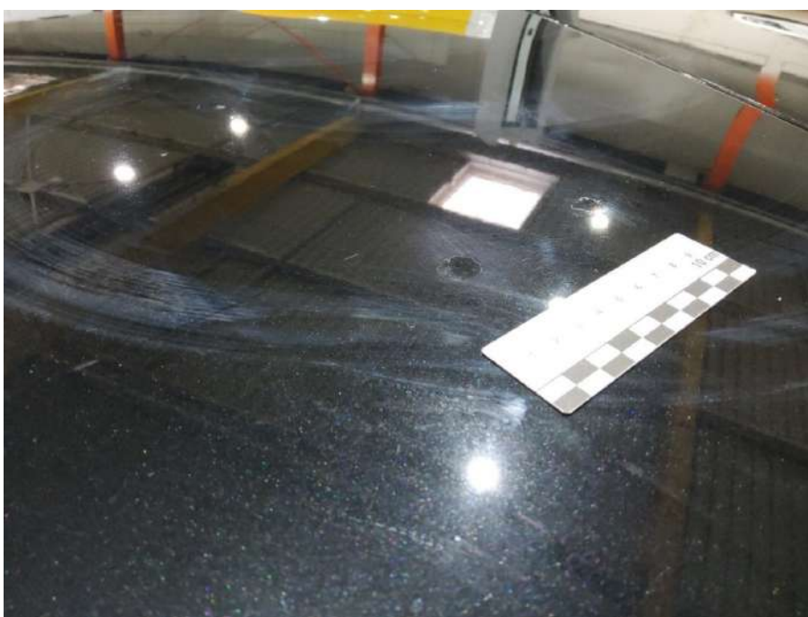
Bild 28 Dach Delle mit Lackbeschäd. - Instandsetzen
