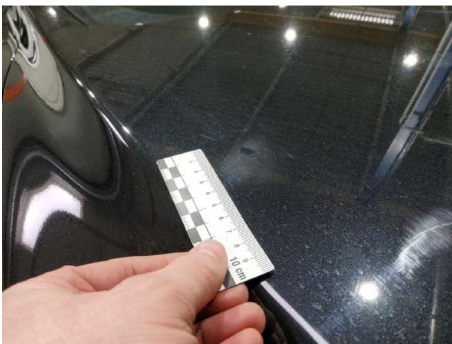
Bild 34 Fahrzeug aussen Lackbeschädigung - Aufbereiten
