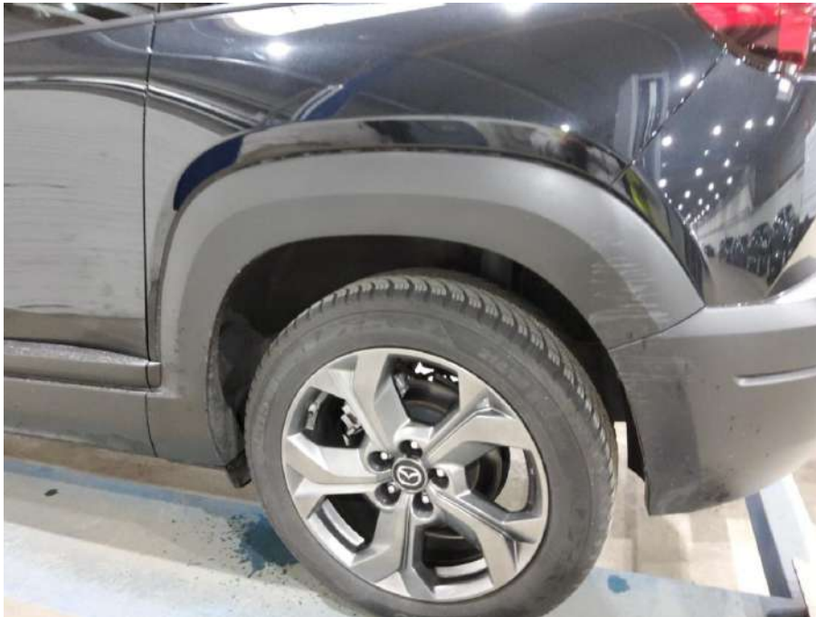
Bild 17 Kotflügelverbreiterung hinten links Verschrammt - Erneuern
