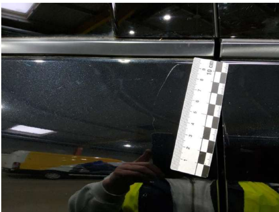
Bild 22 Tür hinten rechts Kratzer - Polieren
