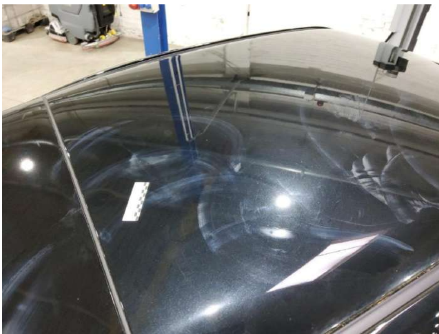
Bild 26 Dach Delle mit Lackbeschäd. - Instandsetzen
