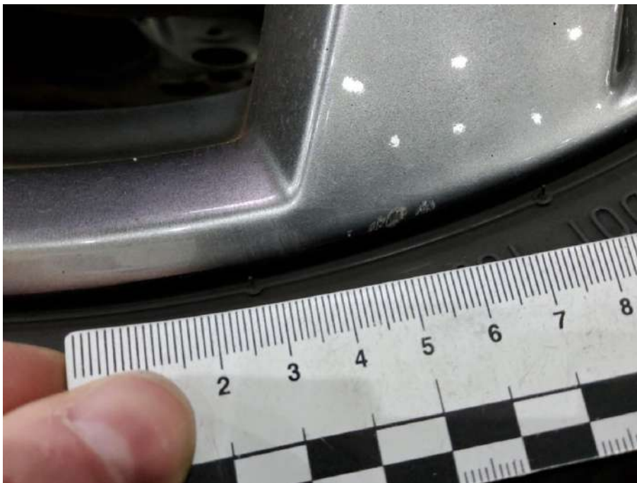
Bild 16 Alufelge vorne rechts Verschrammt
