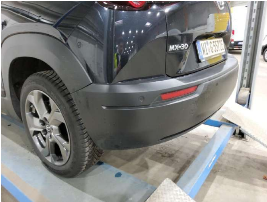
Bild 19 Stoßfänger hinten Verschrammt - Erneuern
