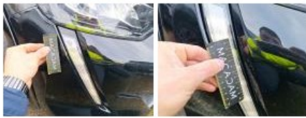
Boitier rétroviseur ext D, Griffes(s), Peindre
