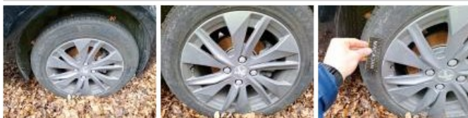
Jante alum. ARG, Griffe(s), Réparer/rempl. (montant forfaitaire)
