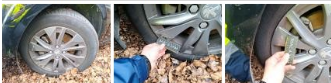
Jante alum. ARG, Griffe(s), Réparer/rempl. (montant forfaitaire)
