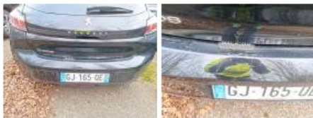
Jupe AR, Déformé / Forcé, Le - Remplacer et peindre
