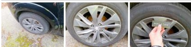
Jante alum. ARD, Griffe(s), E - Remplacer
