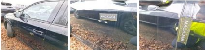
Bas de caisse ext G, Bosse(s) et griffe(s), Le - Remplacer et peindre
