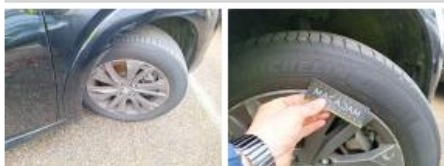
Jante alum. AVD, Griffe(s), E - Remplacer
