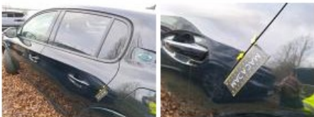
Aile ARG, Bosse(s), LI - Réparer et peindre (complet)
