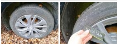
Jante alum. ARD, Griffe(s), E - Remplacer
