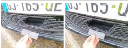
Pare-chocs AV, Cassé, LI - Réparer et peindre (complet)
