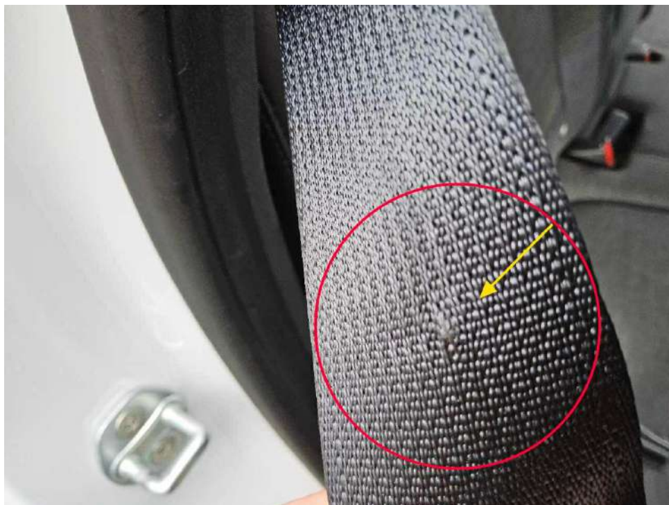
Bild 13 : Gurt hinten rechts beschädigt Loch
