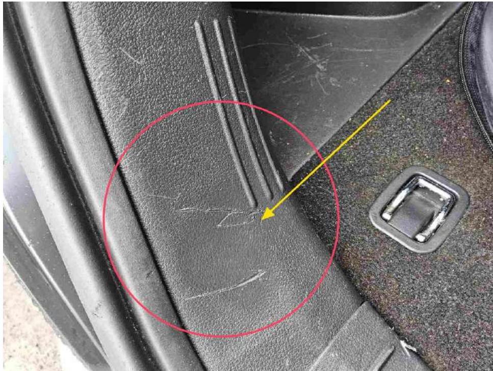
Bild 11 : Seitenwandverkleidung links beschädigt
