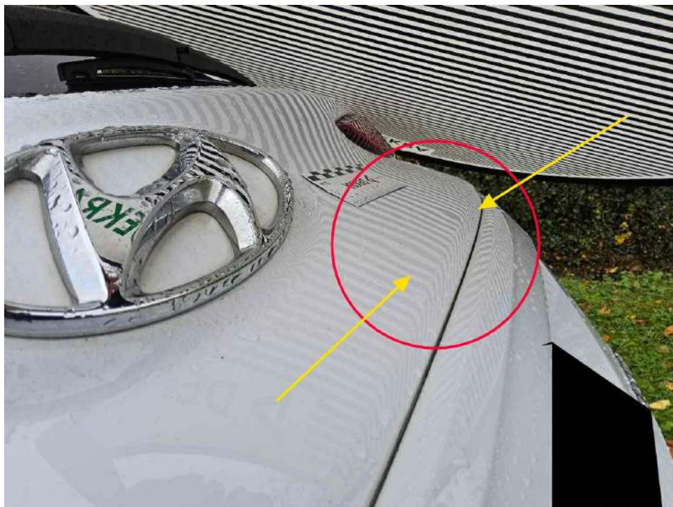
Bild 18 : Heckklappe mehrfach eingedellt
