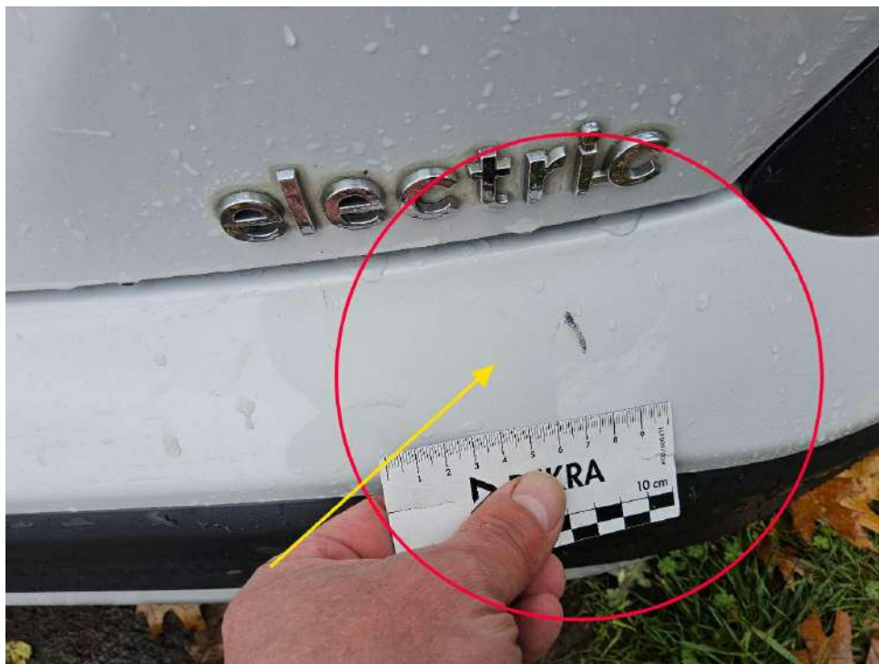
Bild 21 : Stoßstange hinten und Mittelteil verkratzt
