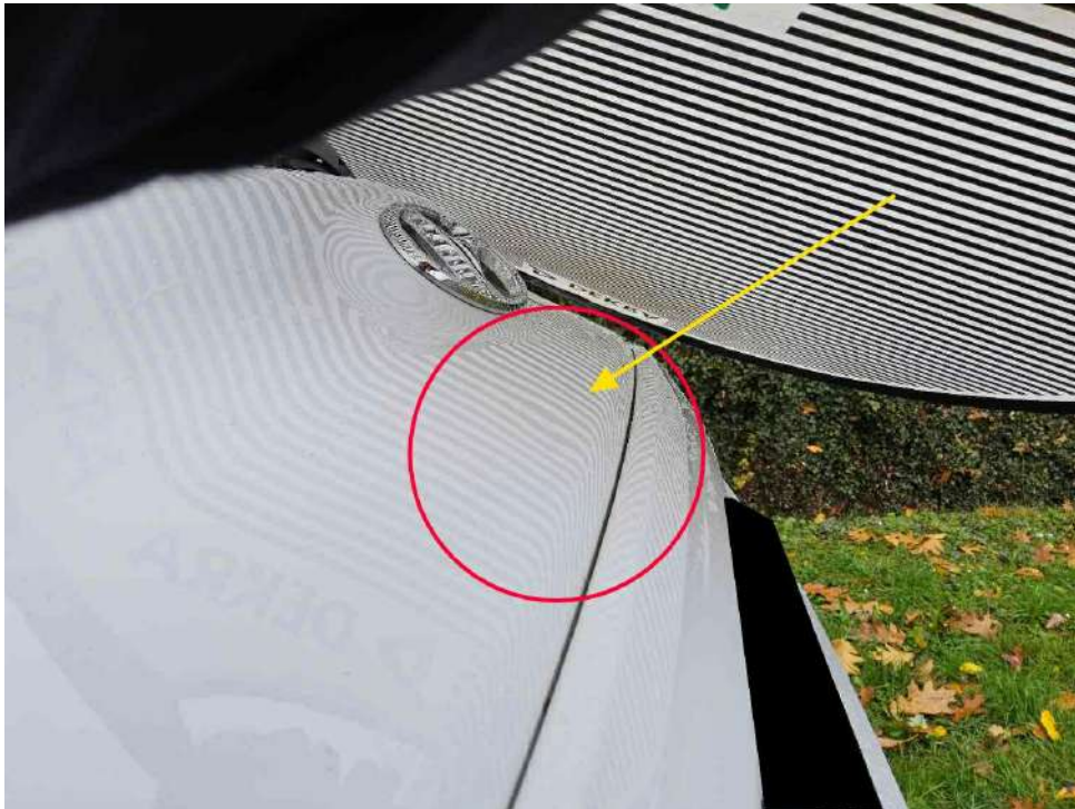
Bild 19 : Heckklappe mehrfach eingedellt
