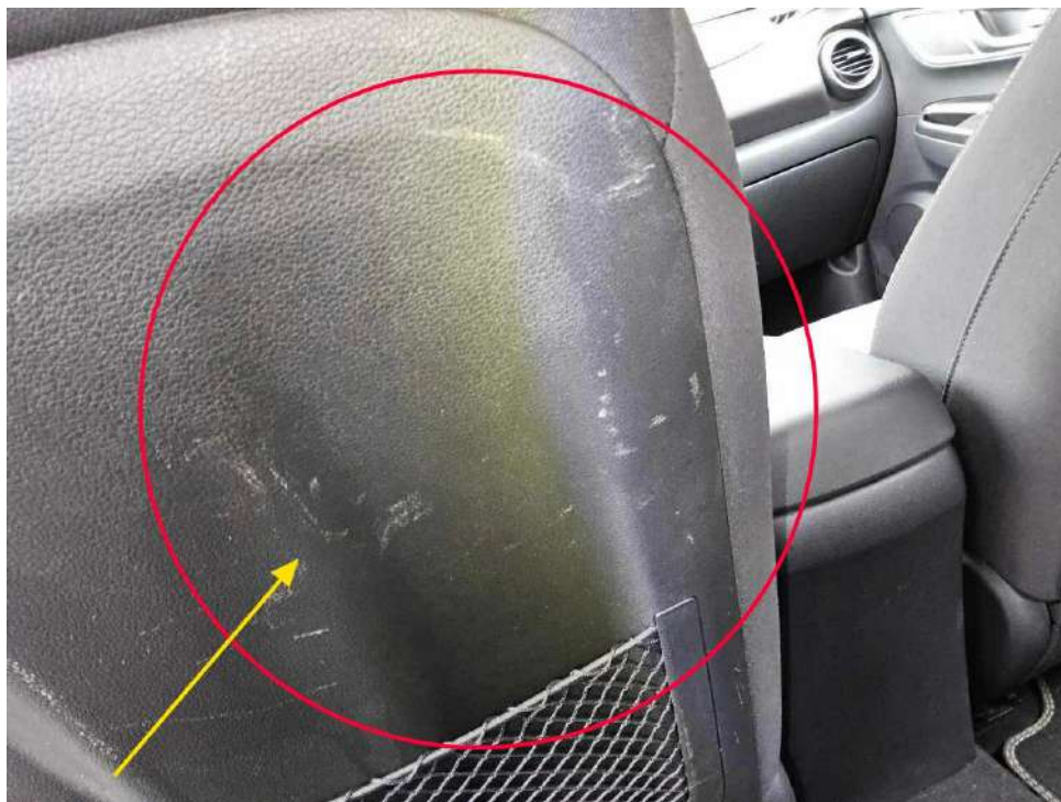
Bild 15 : Sitzlehnenverkleidung links beschädigt
