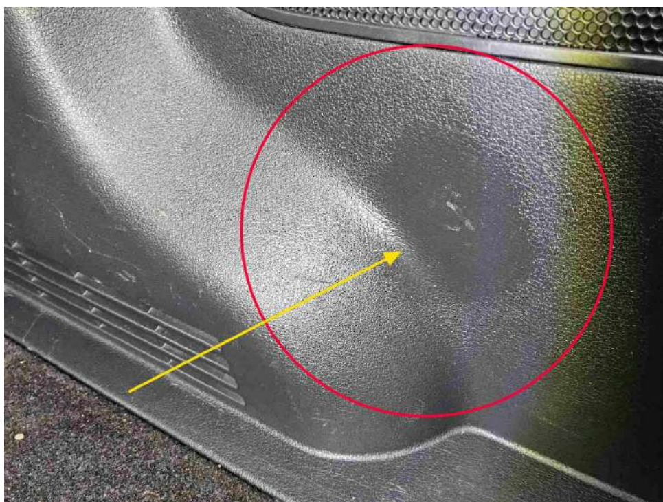
Bild 10 : Seitenwandverkleidung rechts beschädigt
