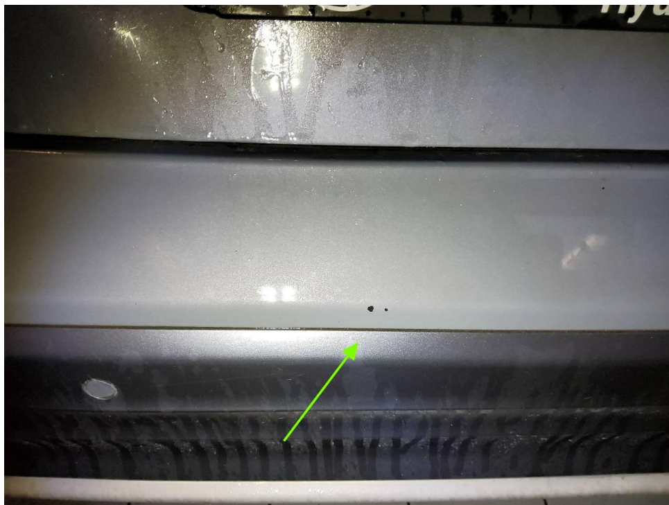
Bild 9 : Kratzer im Ladekantenbereich am Stoßfänger hinten
