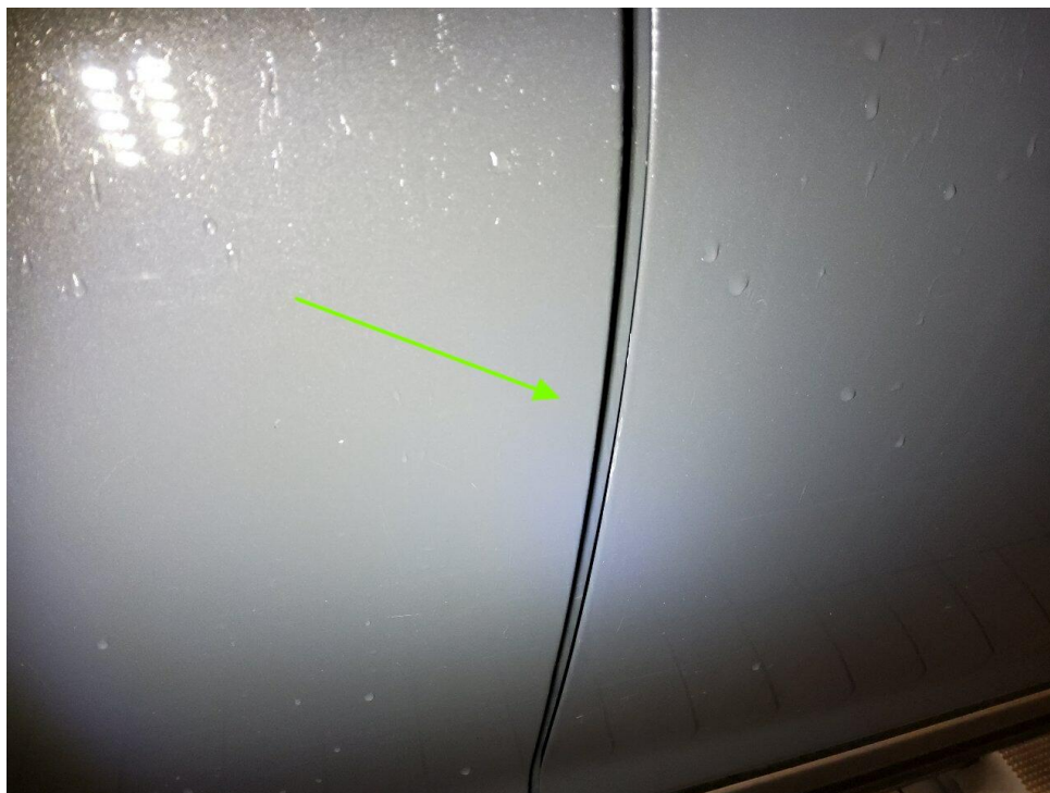
Bild 11 : Lackschaden an Türkanten
