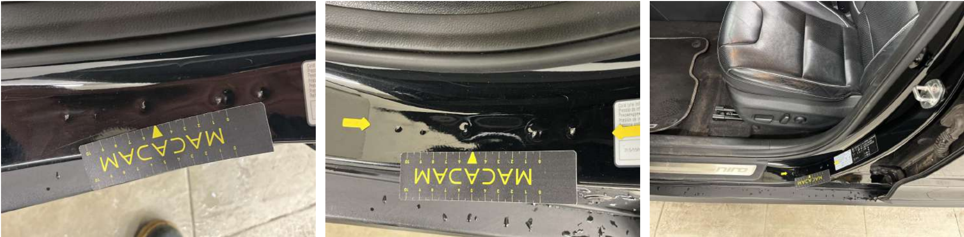
Deurframe V R Deuk(en) en kras(sen) Herstellen en spuiten (gedeeltelijk) Rechts
