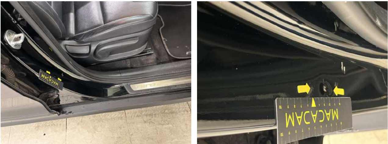
Deurframe V R Deuk(en) en kras(sen) Herstellen en spuiten (gedeeltelijk) Rechts
