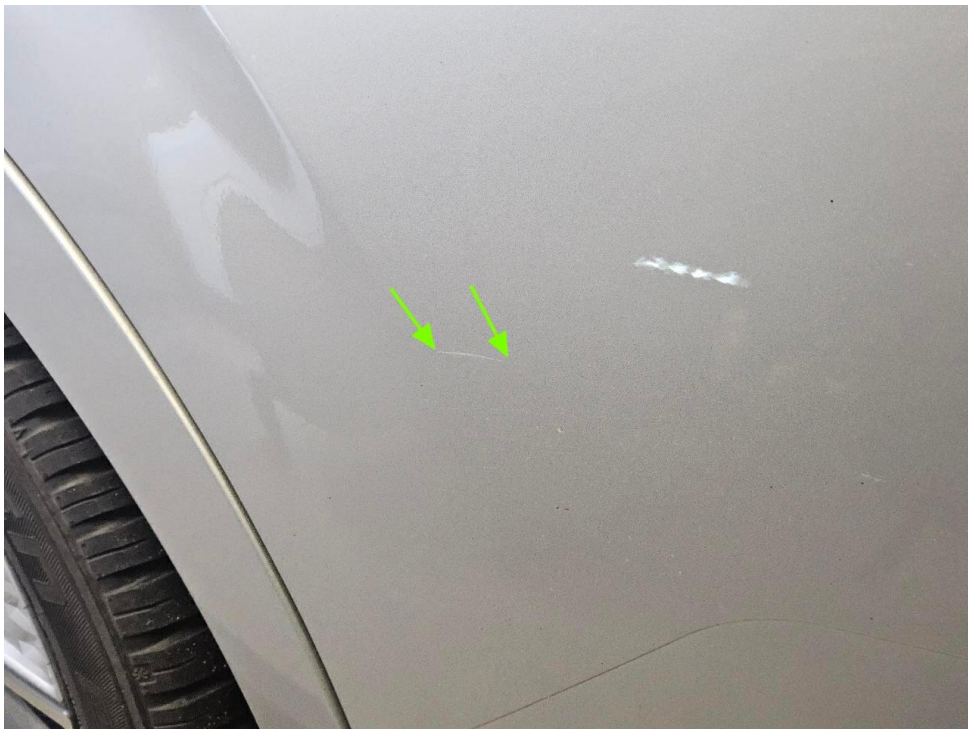
Bild 12 : Tür hinten rechts Lackierung unterhalb, zerkratzt, lackieren
