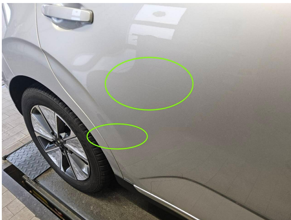
Bild 10 : Tür hinten rechts Lackierung unterhalb, zerkratzt, lackieren
