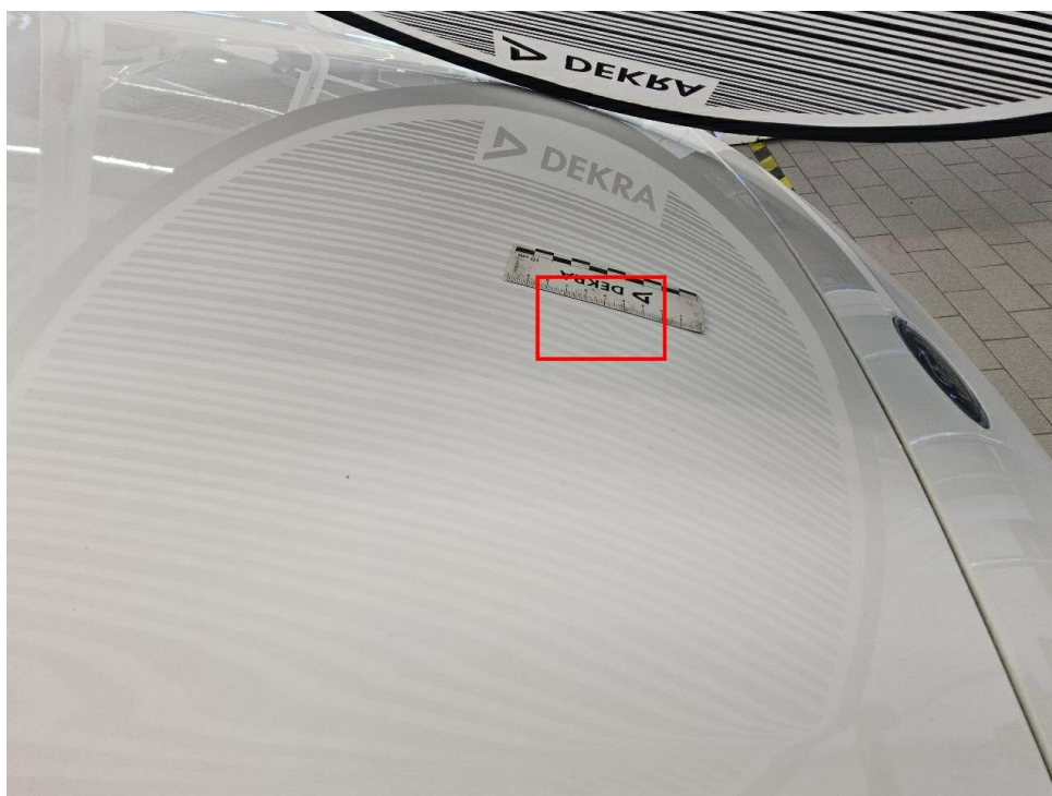
Bild 14 : Motorhaube weist Dellen auf
