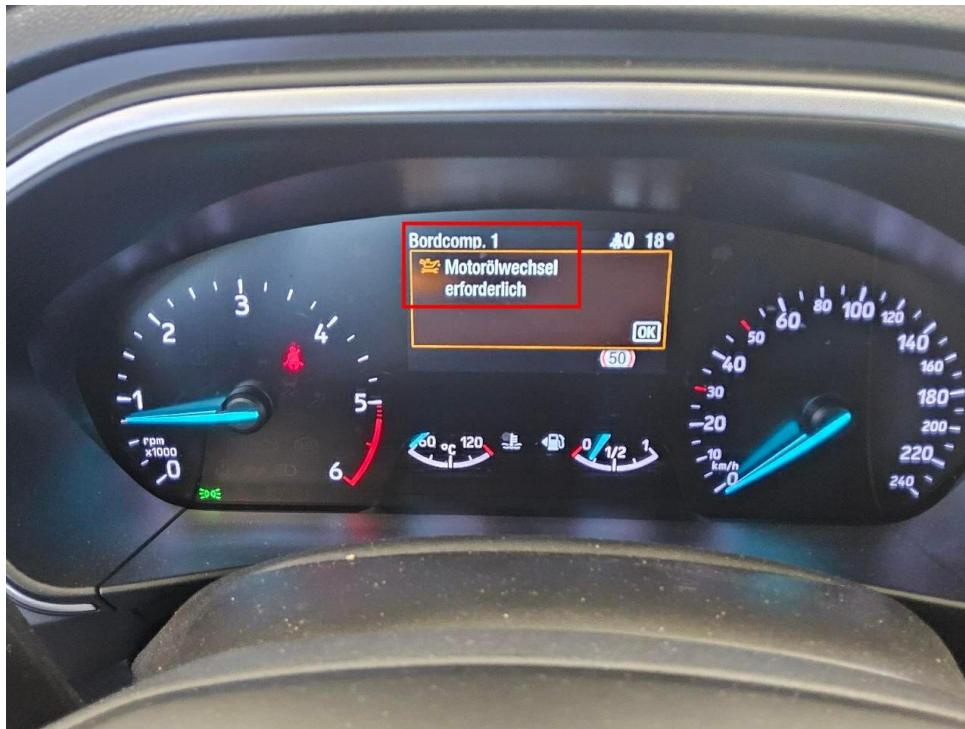
Bild 7 : Wartung ist fällig
