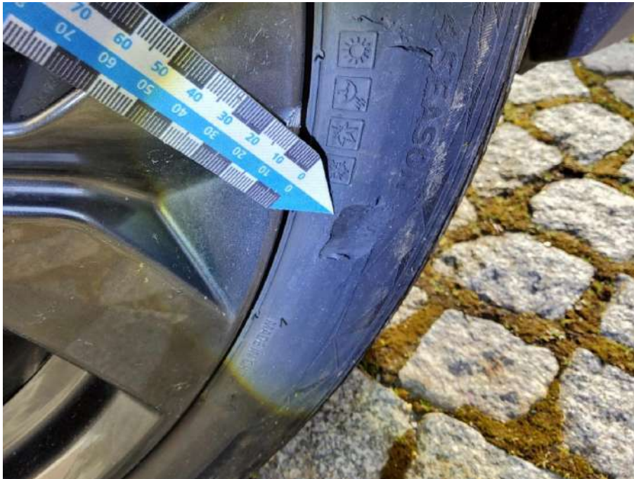
Bild 17 Reifen vorne rechts Beschädigt - Erneuern
