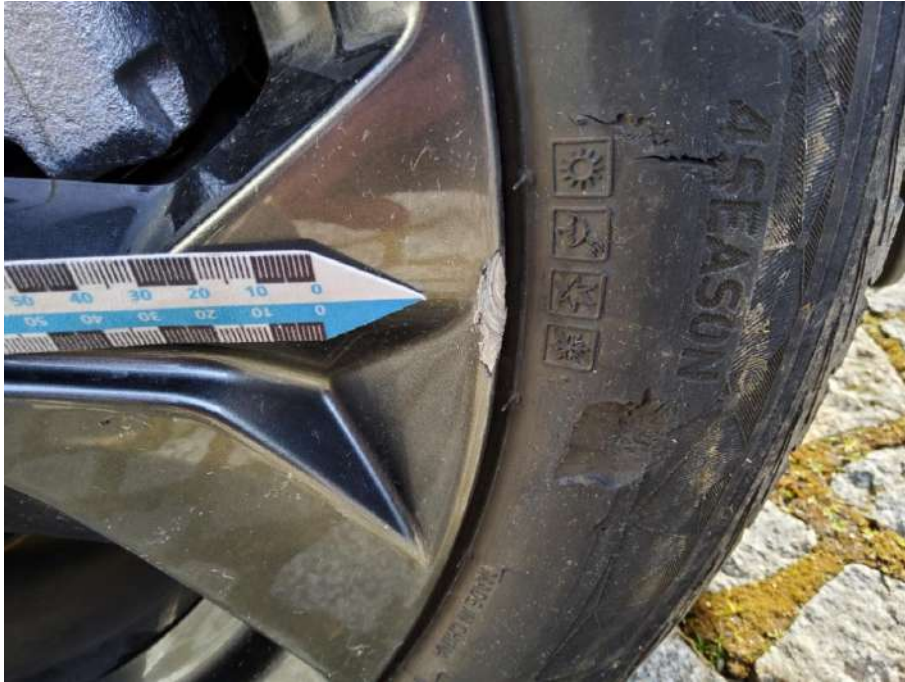
Bild 19 Alufelge 1.Achse rechts Verschrammt - Erneuern
