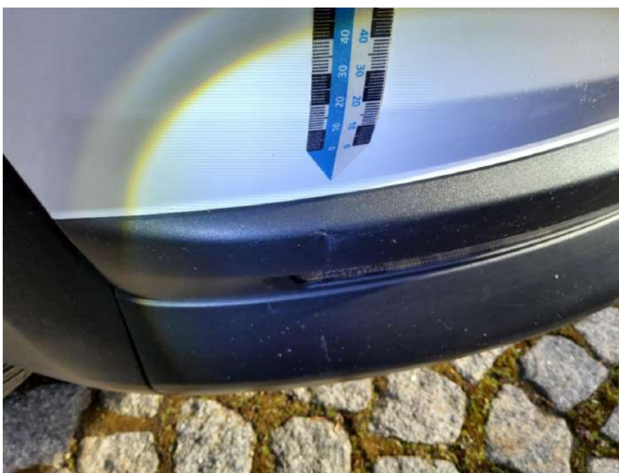
Bild 24 Stoßfänger vorne unterhalb Verformt - Erneuern
