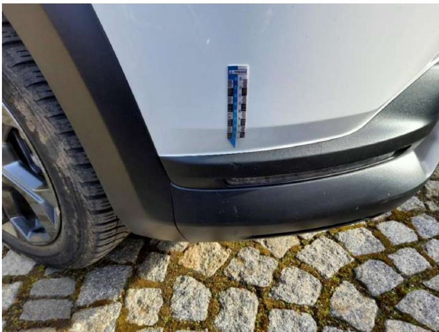
Bild 23 Stoßfänger vorne unterhalb Verformt - Erneuern
