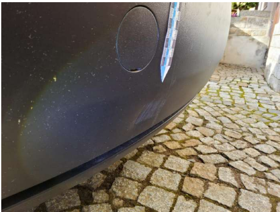
Bild 31 Stoßfänger hinten Verformt - Erneuern
