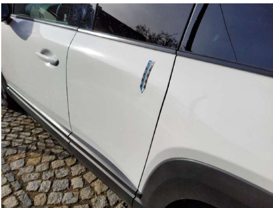
Bild 28 Tür hinten links Delle - Smart repair
