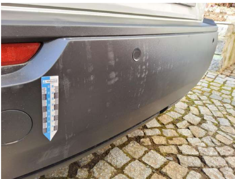
Bild 32 Stoßfänger hinten Verformt - Erneuern
