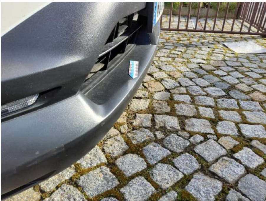
Bild 25 Stoßfänger vorne unterhalb Verformt - Erneuern
