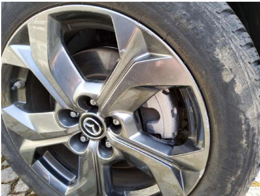
Bild 20 Alufelge 1.Achse rechts Verschrammt - Erneuern
