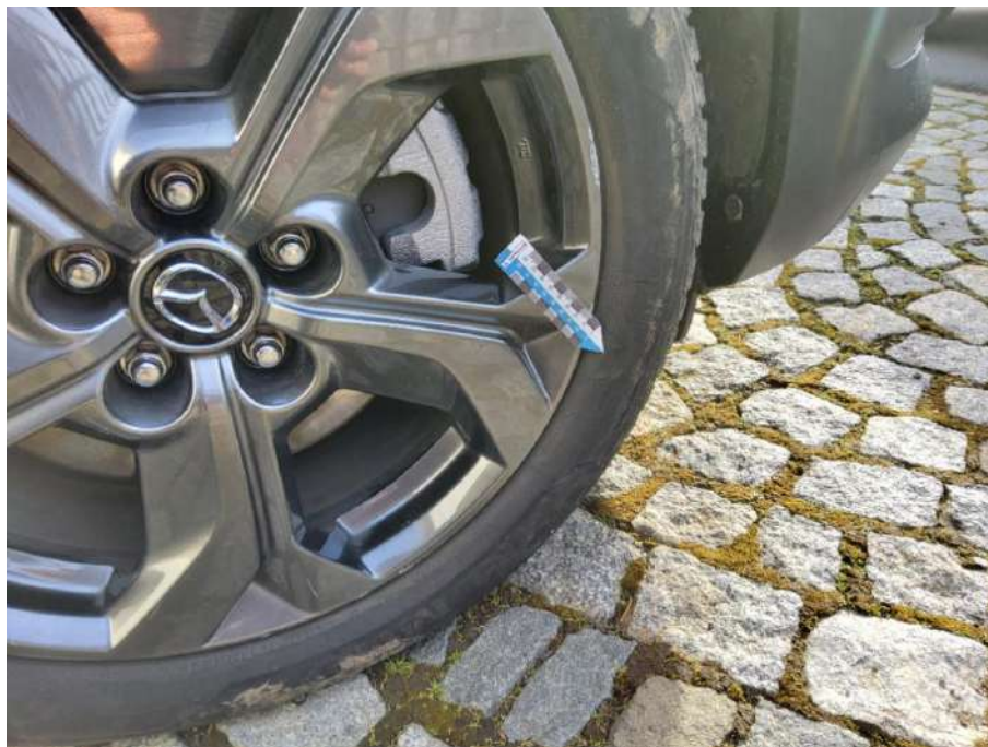
Bild 16 Reifen vorne rechts Beschädigt - Erneuern
