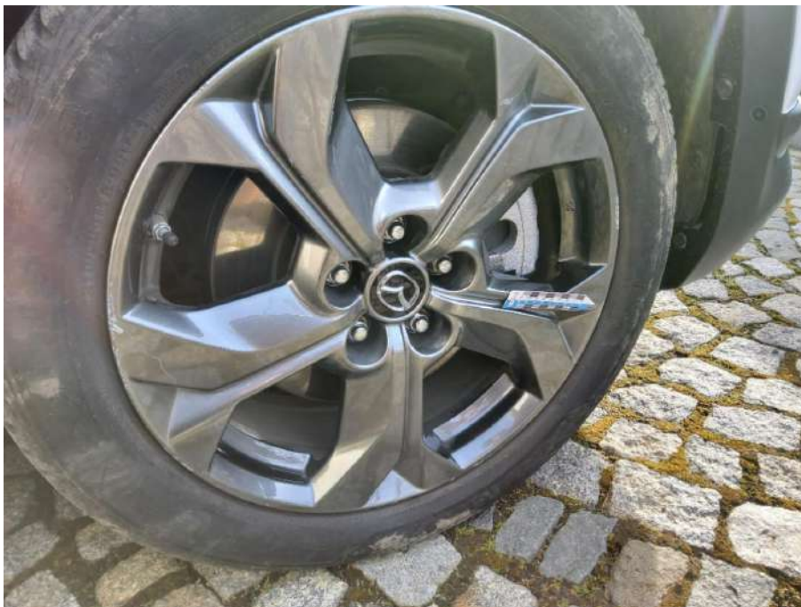
Bild 18 Alufelge 1.Achse rechts Verschrammt - Erneuern
