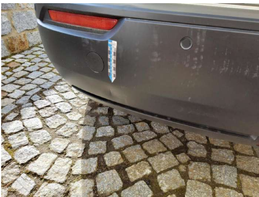
Bild 30 Stoßfänger hinten Verformt - Erneuern
