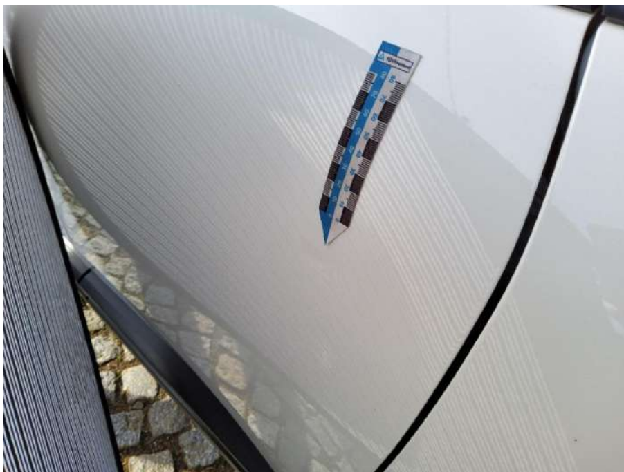
Bild 29 Tür hinten links Delle - Smart repair
