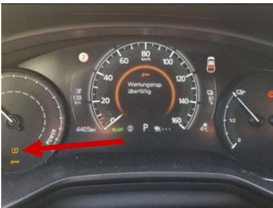
Bild 36 Fehlermeldung Aktive Meldung vorhanden - Befundung (Fehlermeldung Reifendruck. Kostenerweiterung möglich)
