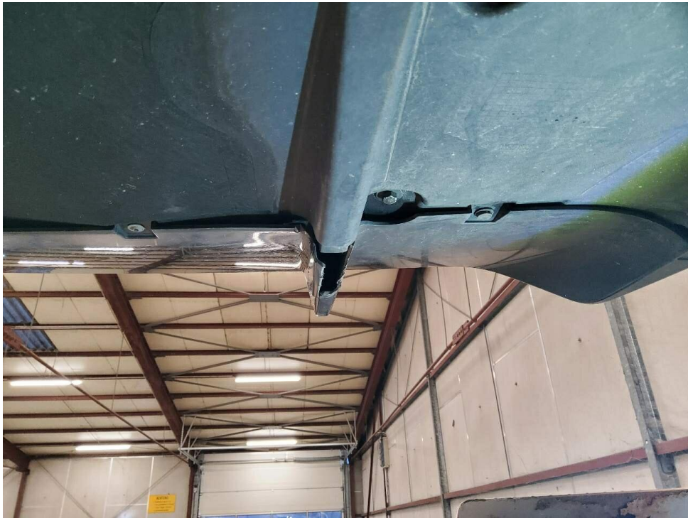
Bild 10 : Unterfahrschutz hinten gebrochen
