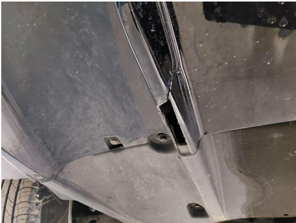
Bild 11 : Unterfahrschutz hinten gebrochen
