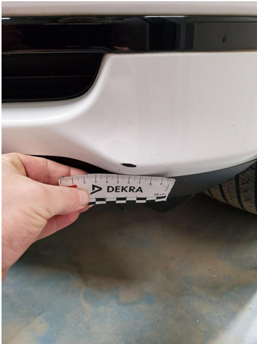
Bild 7 : Stoßfänger vorne, Kratzer , lackieren mit Lackaufbau
