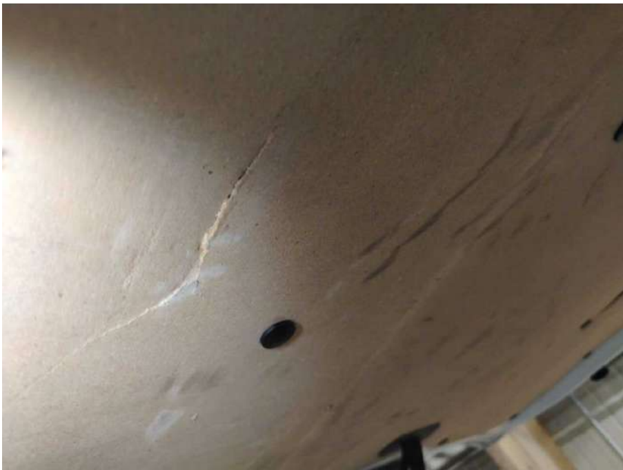
Bild 32 Innenraum Heckklappenverkleidung innen gebrochen
