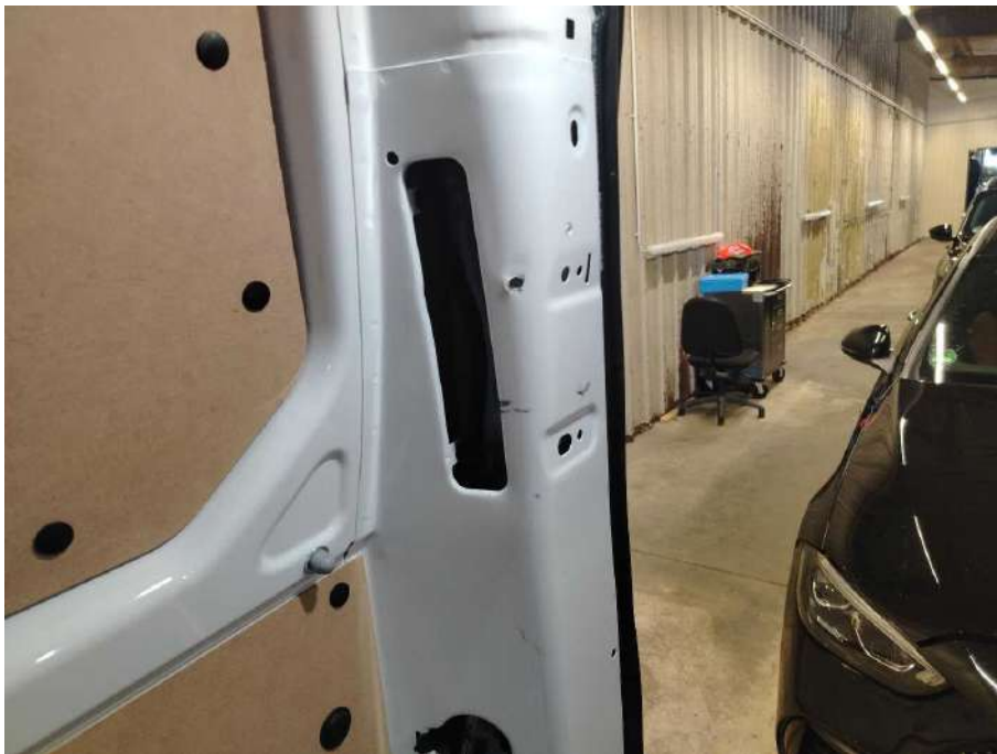
Bild 29 rechte Seite D-Säule rechts beschädigt
