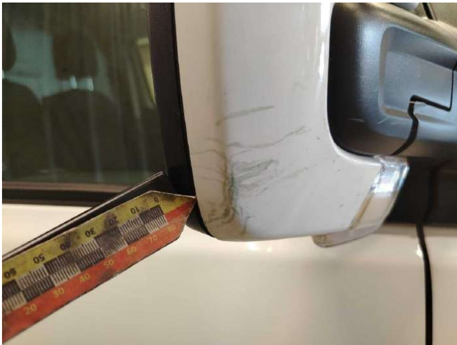
Bild 49 rechte Seite Außenspiegelgehäuse rechts verkratzt
