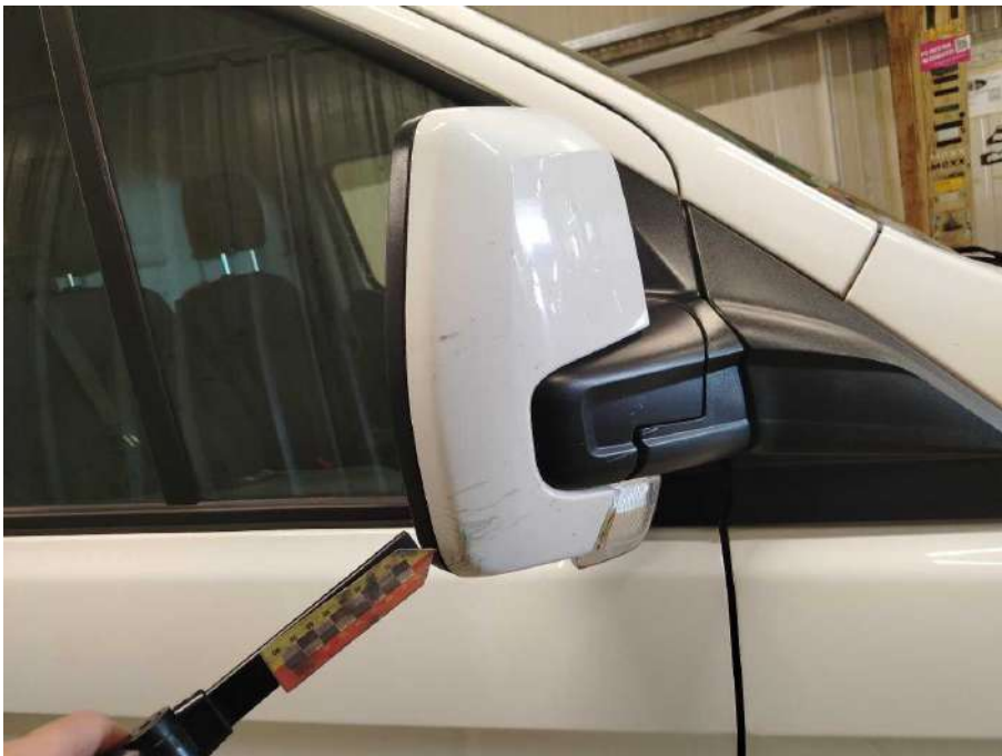
Bild 48 rechte Seite Außenspiegelgehäuse rechts verkratzt
