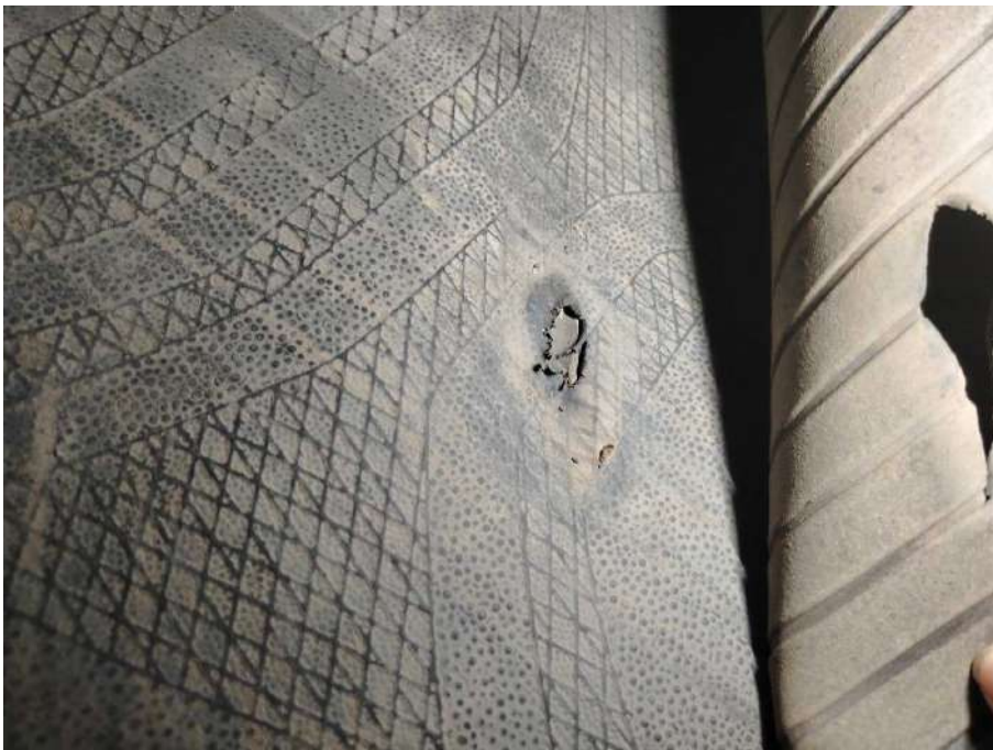
Bild 20 Innenraum Fußraum Bodenbelag beschädigt
