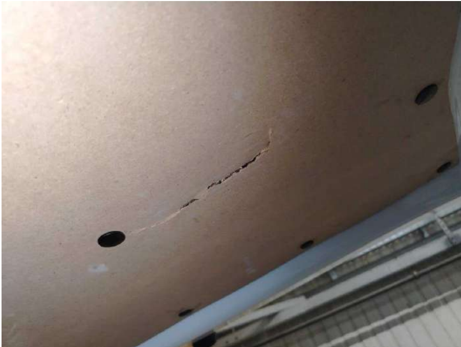
Bild 33 Innenraum Heckklappenverkleidung innen gebrochen
