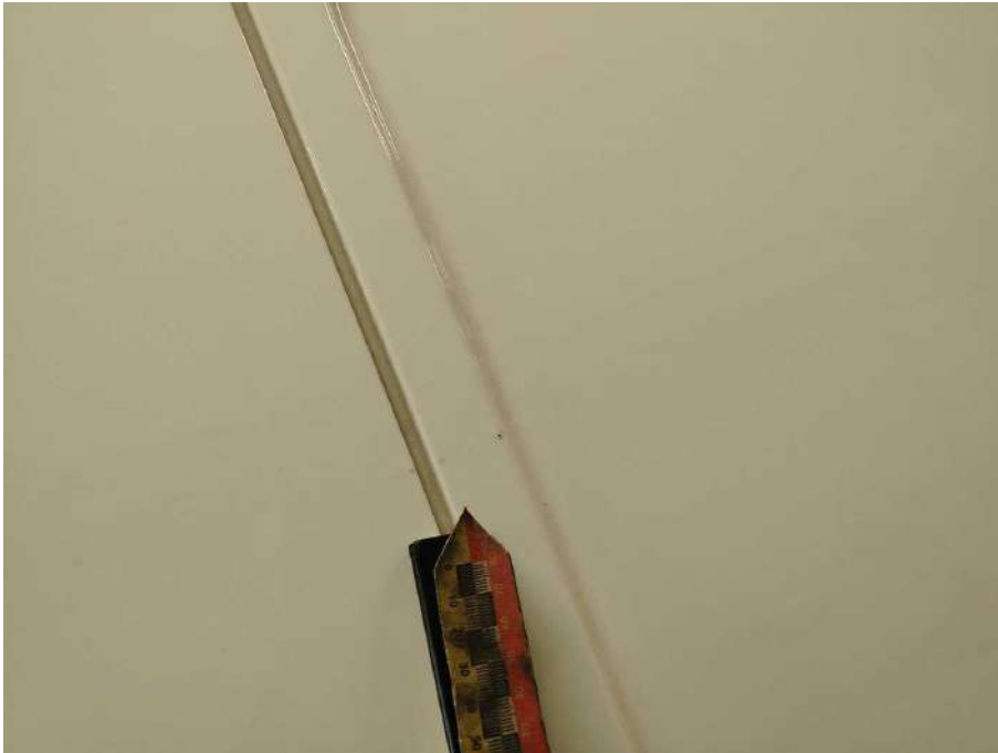
Bild 43 linke Seite Tür vorne links und Seitenwand links Kratzer
