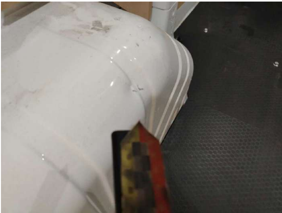
Bild 24 linke Seite Radhausschale hinten links deformiert
