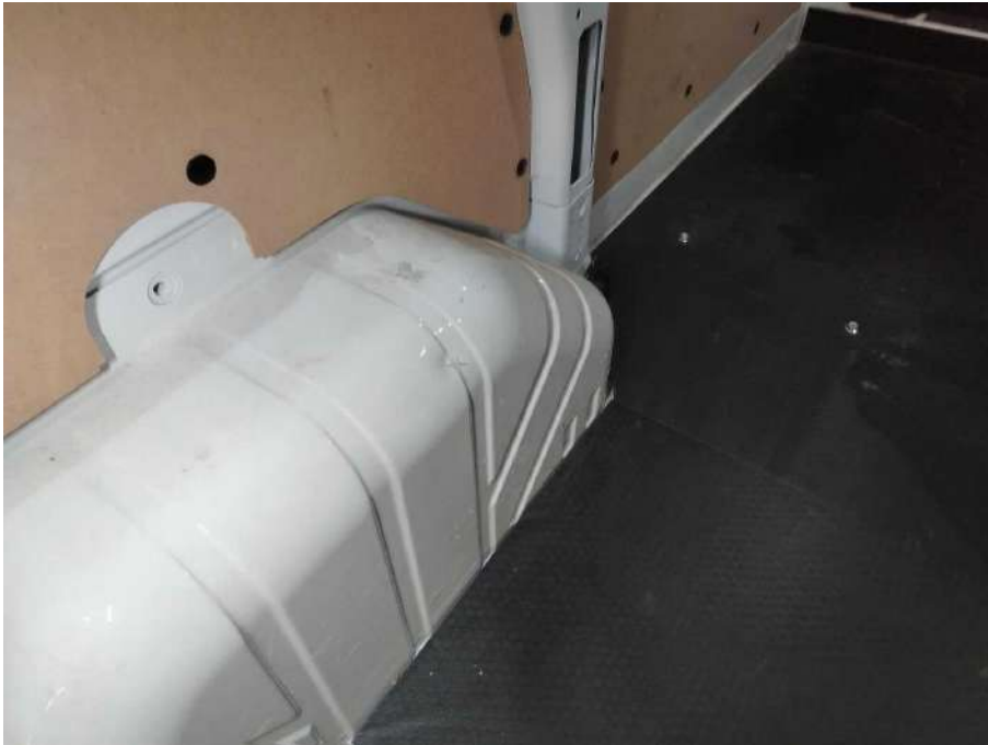
Bild 23 linke Seite Radhausschale hinten links deformiert
