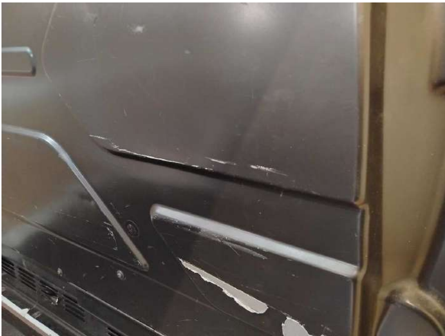
Bild 34 Fahrzeug Trennwand Laderaum verformt
