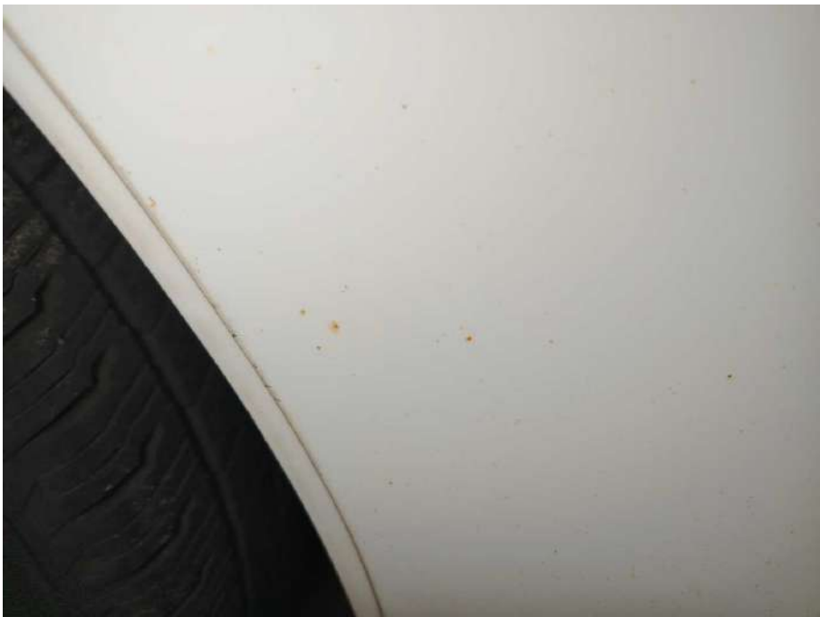
Bild 40 Fahrzeug Fahrzeug komplett Flugrost korrodiert
