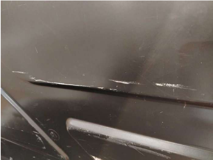
Bild 35 Fahrzeug Trennwand Laderaum verformt
