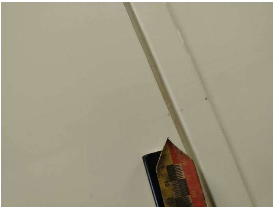
Bild 42 linke Seite Tür vorne links und Seitenwand links Kratzer
