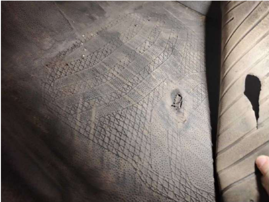
Bild 19 Innenraum Fußraum Bodenbelag beschädigt
