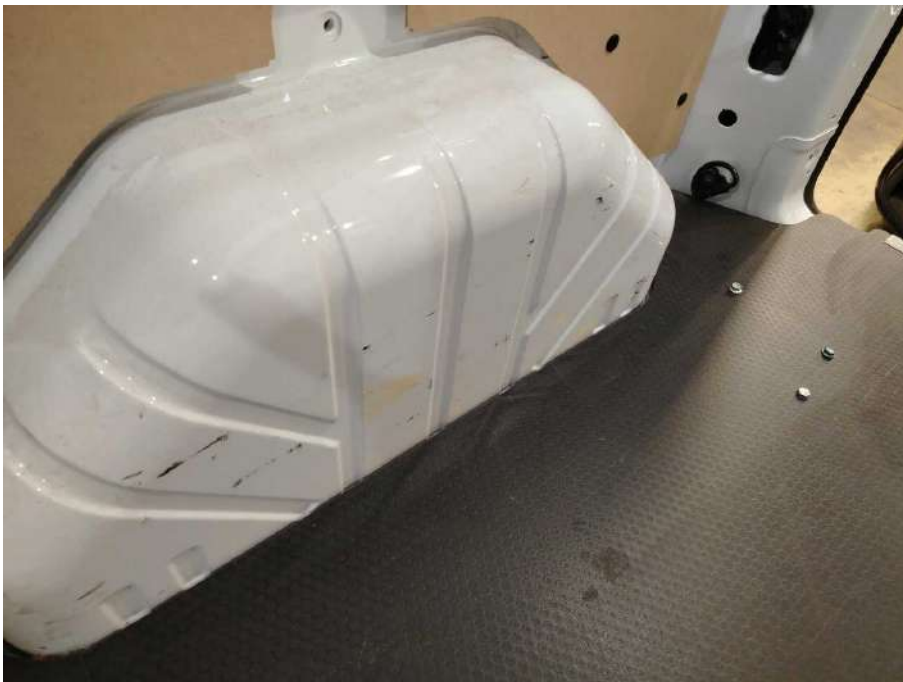
Bild 28 rechte Seite Radhausschale hinten rechts verkratzt
