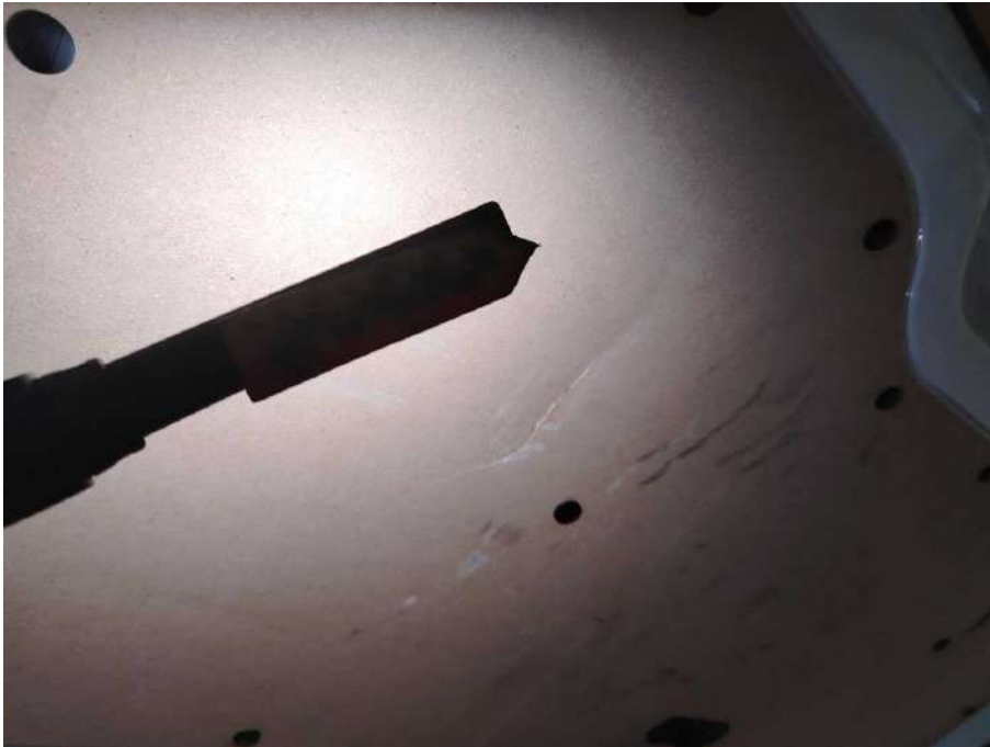
Bild 31 Innenraum Heckklappenverkleidung innen gebrochen
