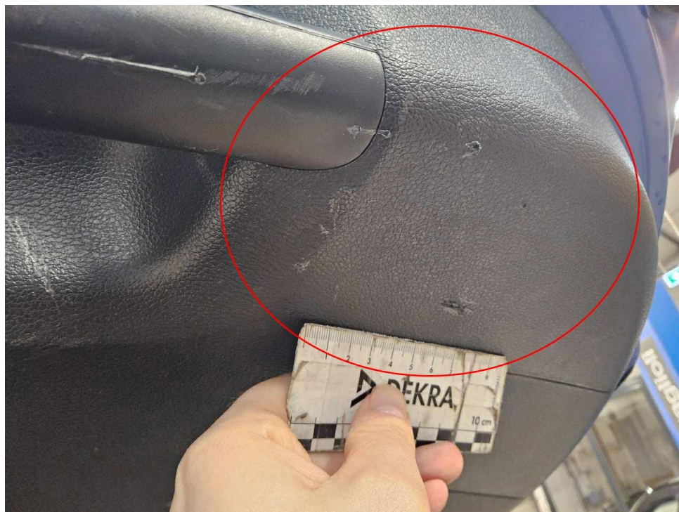
Bild 15 : Kofferraumklappe Innenverkleidung verschrammt
