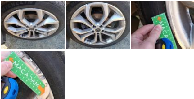
Alloy rim RL, Scratch(es), Repair/replace (lump sum)
