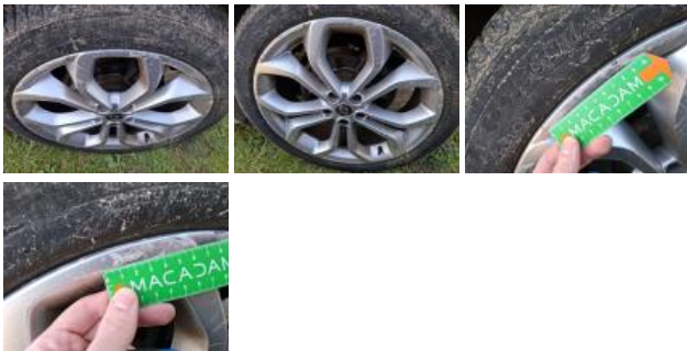
Alloy rim RR, Scratch(es), Repair/replace (lump sum)
