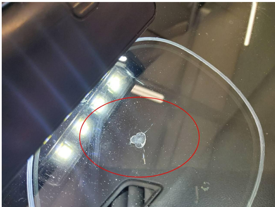
Bild 15 : Frontscheibe reparierter Steinschlag mit Rissbildung
