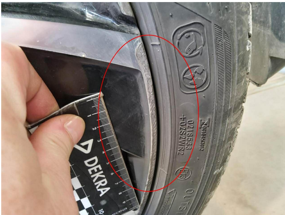
Bild 8 : Felge vorne rechts Lackierung, verschrammt, smart repair
