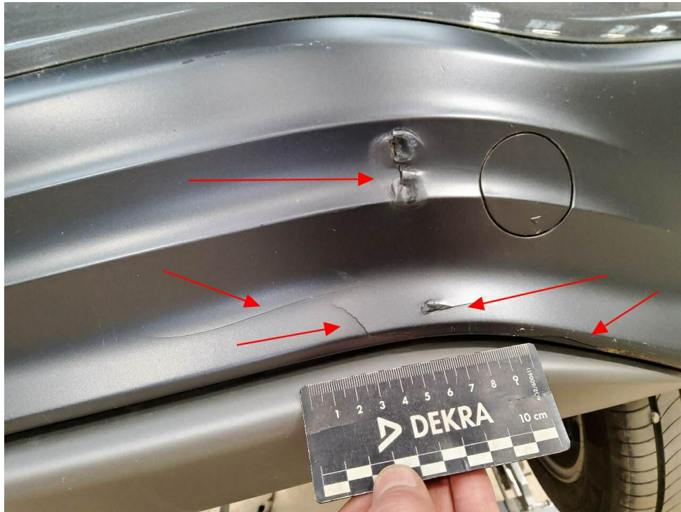
Bild 9 : Stoßfänger hinten gebrochen
