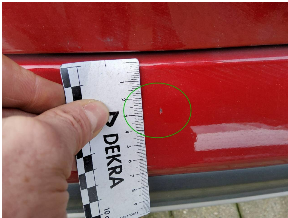
Bild 20 : Stoßfänger hinten, kleine Lackschäden, auslegen
