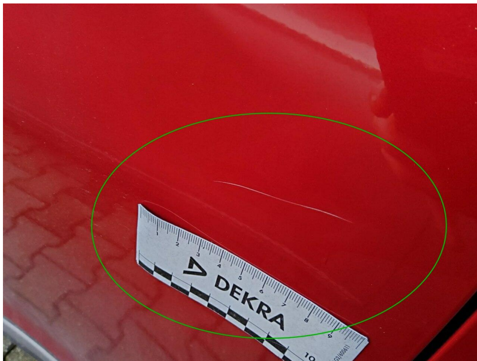
Bild 12 : Tür vorne rechts Lackierung, zerkratzt, lackieren mit Lackaufbau
