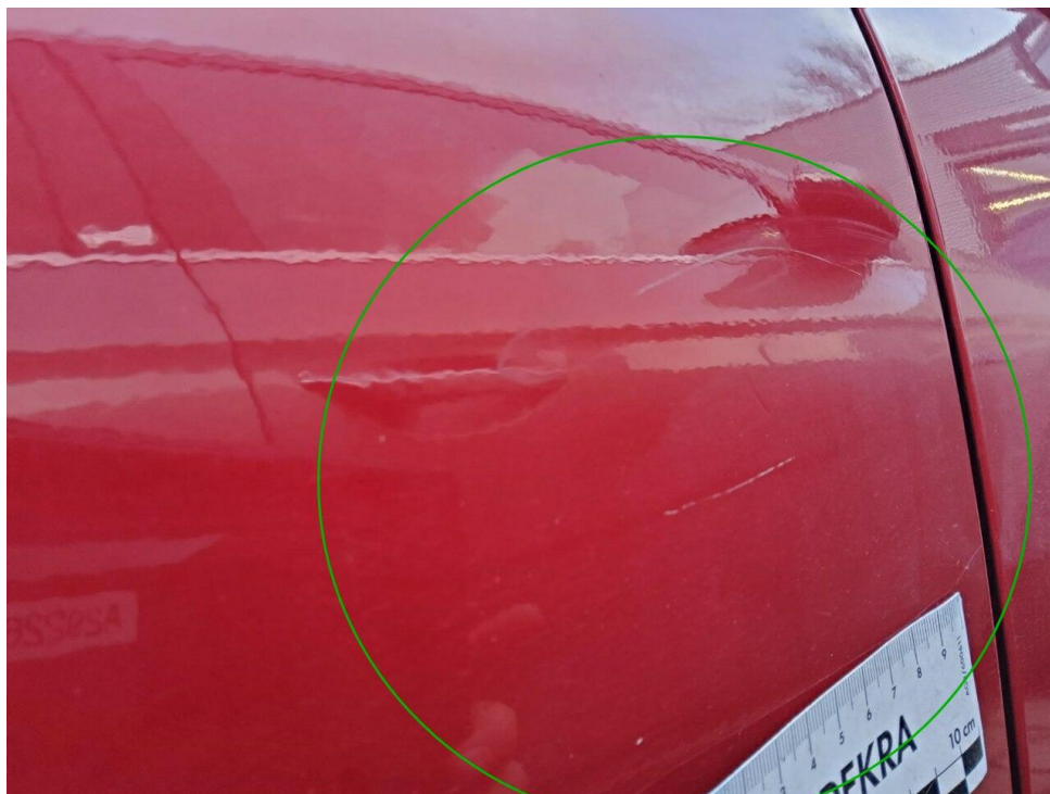
Bild 10 : Tür hinten rechts Lackierung, zerkratzt, lackieren mit Lackaufbau
