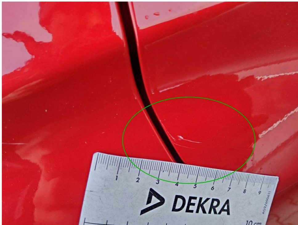
Bild 9 : Tür hinten rechts Lackierung, zerkratzt, lackieren mit Lackaufbau
