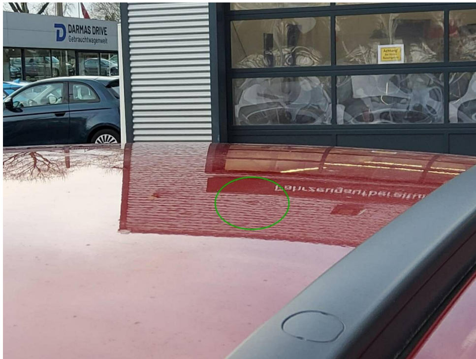
Bild 15 : Dach, deformiert, drücken
