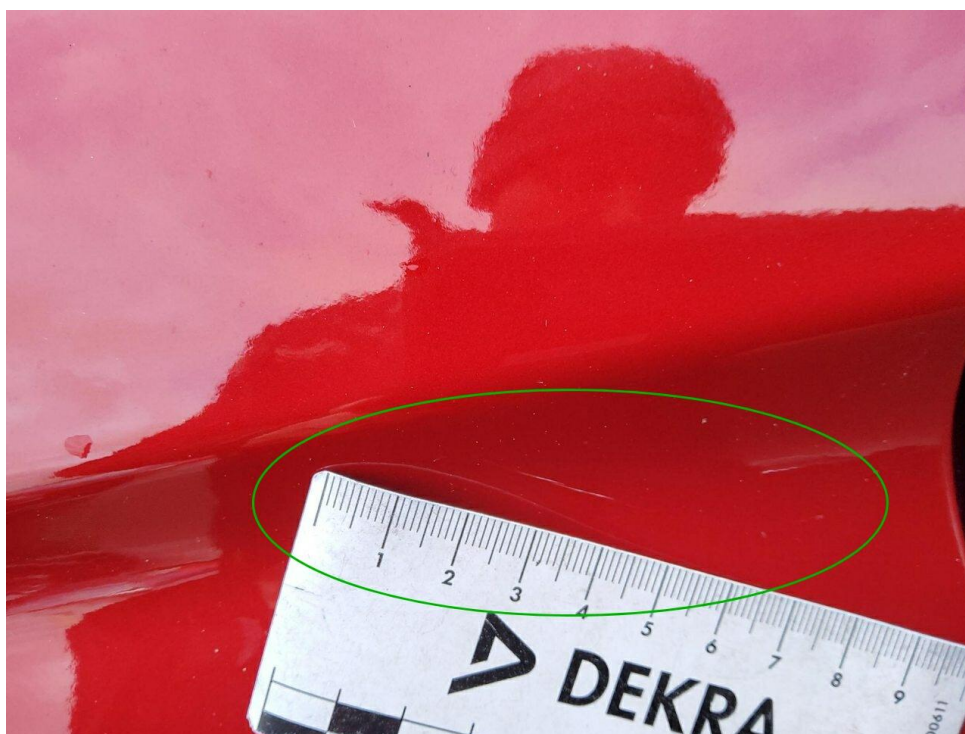
Bild 8 : Seitenteil hinten rechts Lackierung unterhalb, zerkratzt, lackieren mit Lackaufbau
