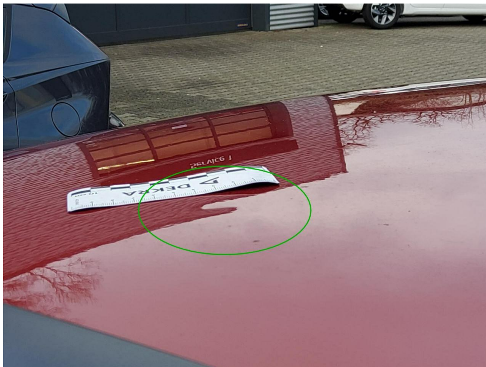
Bild 19 : Dach, deformiert, drücken
