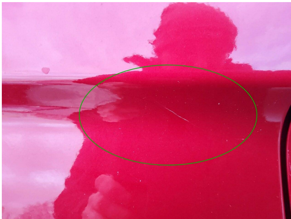
Bild 7 : Seitenteil hinten rechts Lackierung unterhalb, zerkratzt, lackieren mit Lackaufbau
