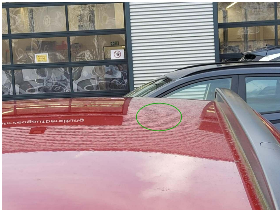
Bild 16 : Dach, deformiert, drücken
