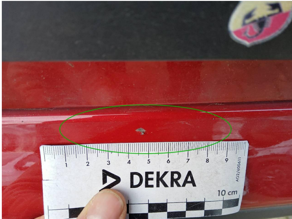
Bild 21 : Stoßfänger hinten, kleine Lackschäden, auslegen
