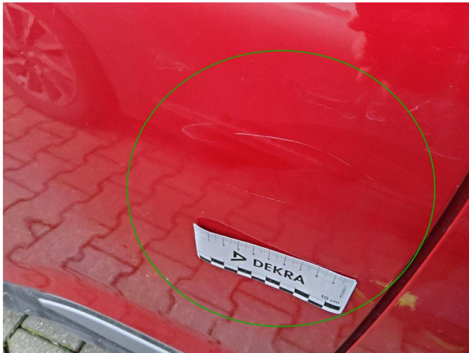
Bild 11 : Tür hinten rechts Lackierung, zerkratzt, lackieren mit Lackaufbau
