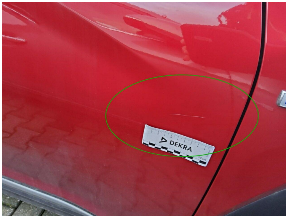
Bild 13 : Tür vorne rechts Lackierung, zerkratzt, lackieren mit Lackaufbau
