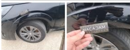
Bas de caisse ext G, Bosse(s) et griffe(s), Le - Remplacer et peindre
