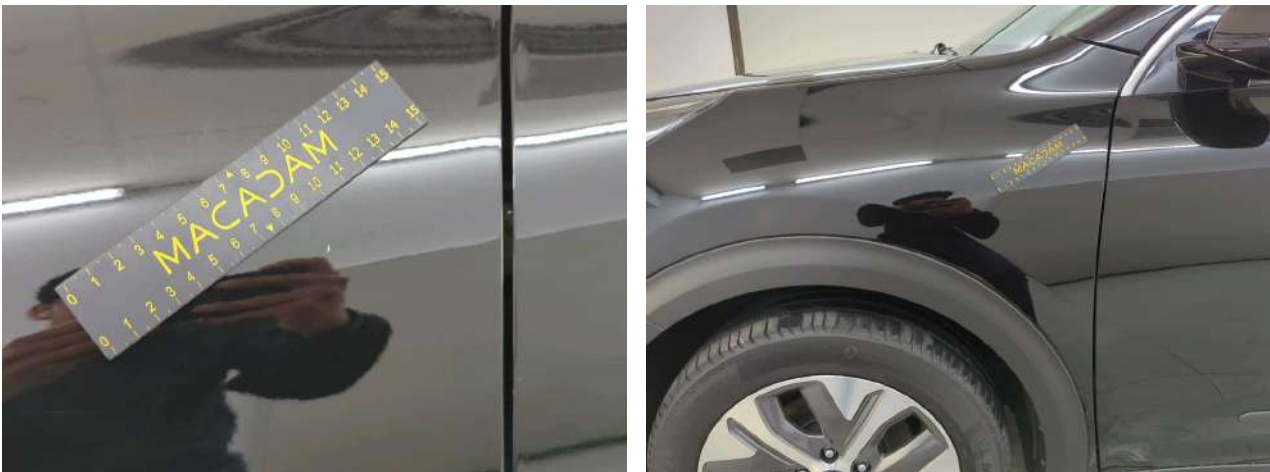
Scherf V L Kras(sen) Herstellen en spuiten (gedeeltelijk) Links
