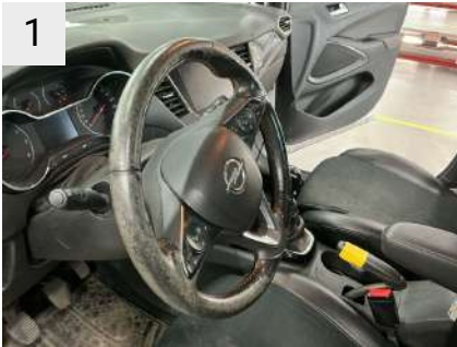
1 Sted Interiør Del Rat Type Slidt
