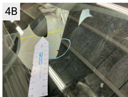
4B Sted Forrude Del Rude Type Stenslag
