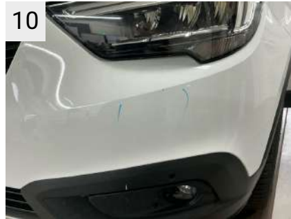
10 Sted Front Del Forkofanger Type Ridser
