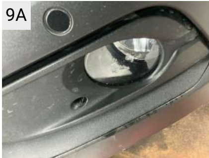
9A Sted Front Del Tågelygte, Venstre Type Ridser
