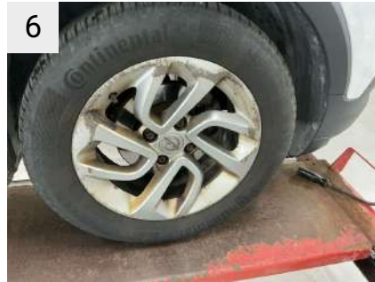
6 Sted Fælge Del Fælg Højre, For Type Ridset
