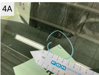
4A Sted Forrude Del Rude Type Stenslag
