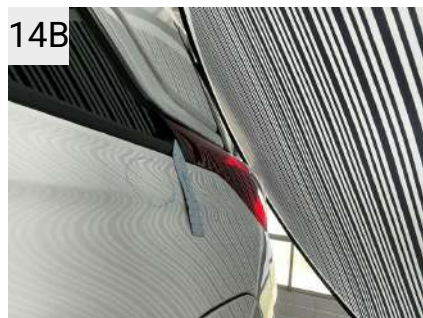
14B Sted V. bagskærm Del Skærm Type Bulet/Ridset
