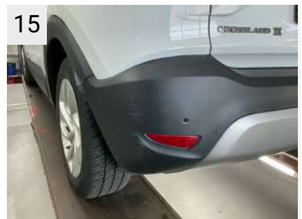
15 Sted Bagkofanger Del Kofanger Type Ridser
