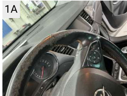
1A Sted Interiør Del Rat Type Slidt
