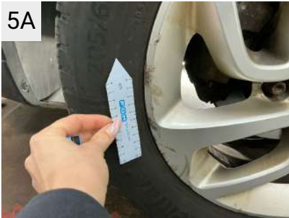
5A Sted Fælge Del Fælg Venstre, For Type Ridset
