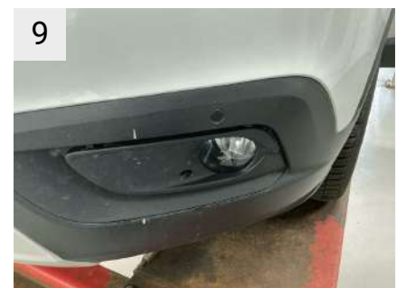
9 Sted Front Del Tågelygte, Venstre Type Ridser
