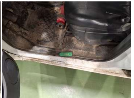
Deurkozijnafdichting / Vooraan links / Scheur
