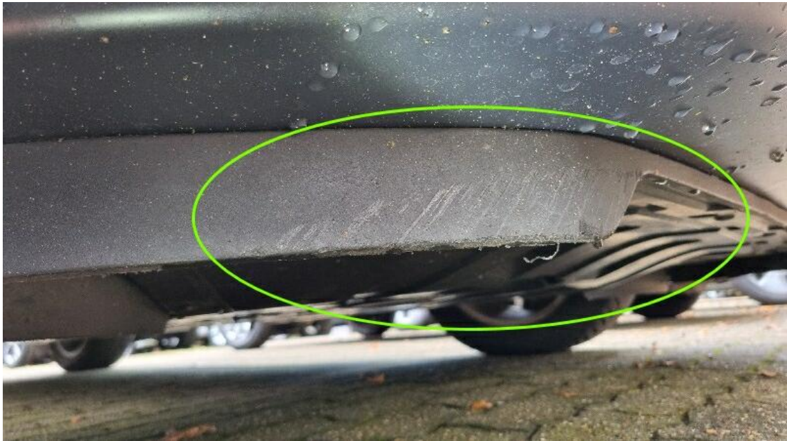
Bild 13 : Spoilerlippe Stoßfänger vorne verschrammt
