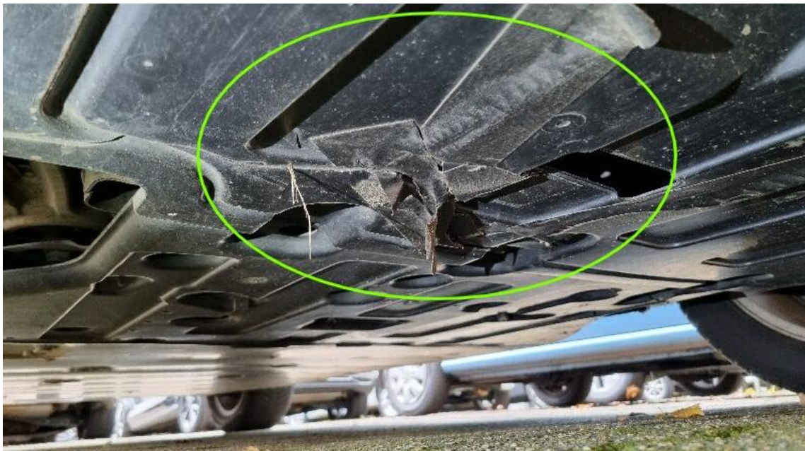
Bild 12 : Unterfahrschutz vorne gebrochen, erneuern
