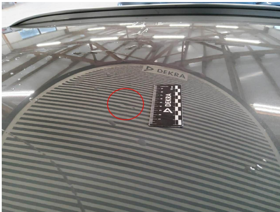
Bild 7 : Dach, eingedellt, smart repair
