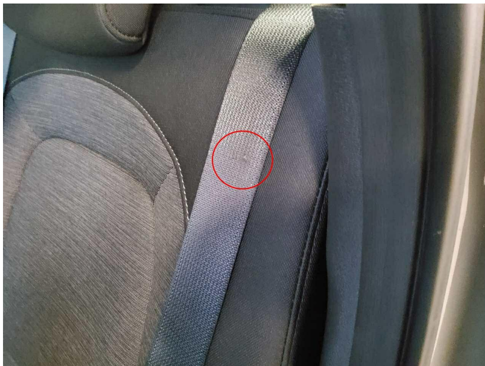
Bild 9 : Gurt hinten links beschädigt
