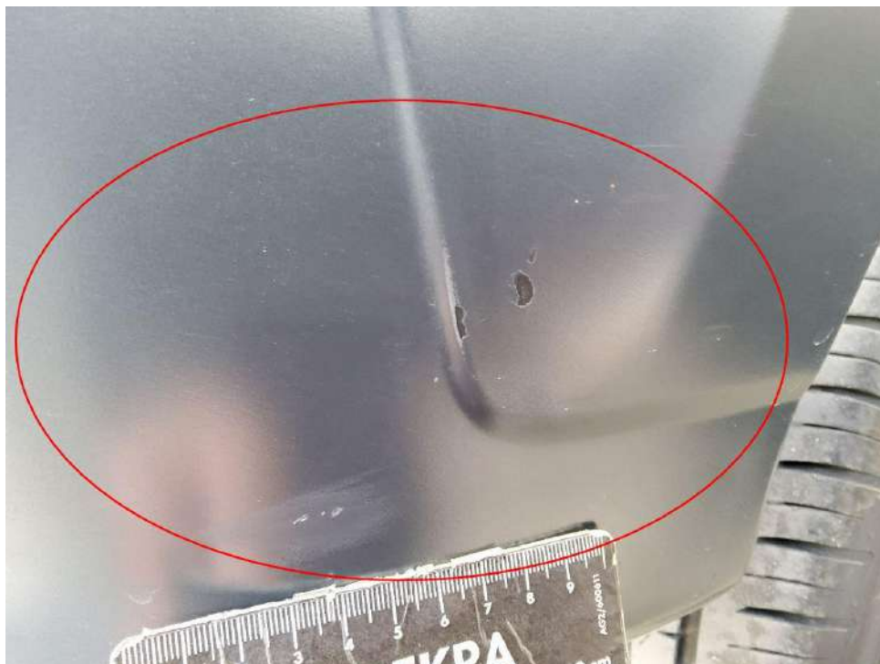
Bild 23 : Kunststoff Blende Stoßfänger hinten verschrammt
