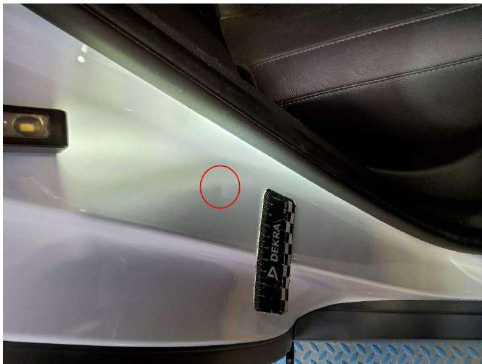
Bild 15 : Einstieg hinten rechts eingedellt
