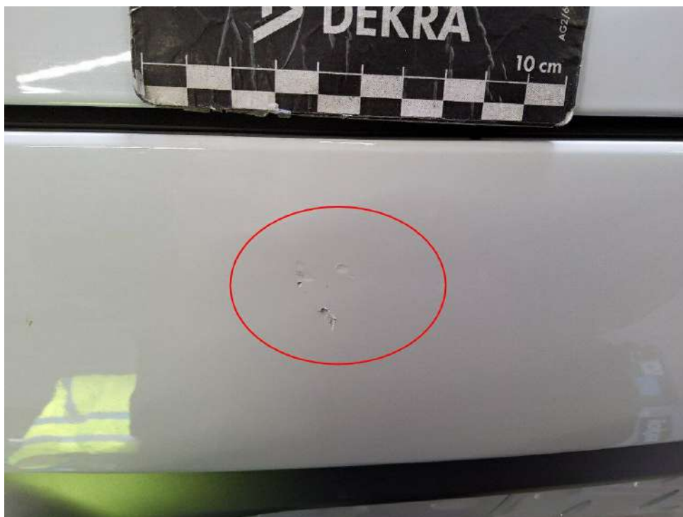
Bild 19 : Frontblech eingedellt, verschrammt
