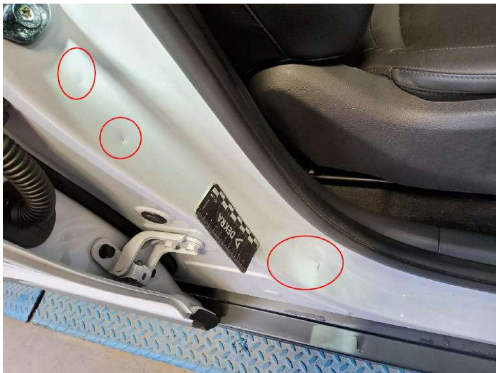
Bild 16 : Einstieg vorne rechts eingedellt, verschrammt
