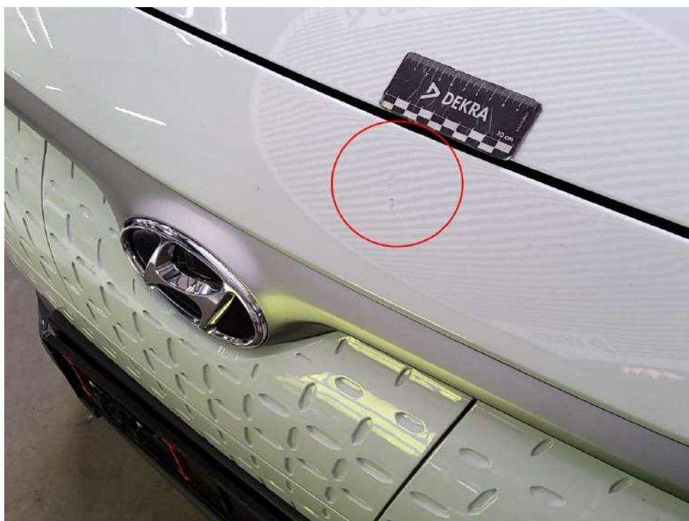
Bild 18 : Frontblech eingedellt, verschrammt
