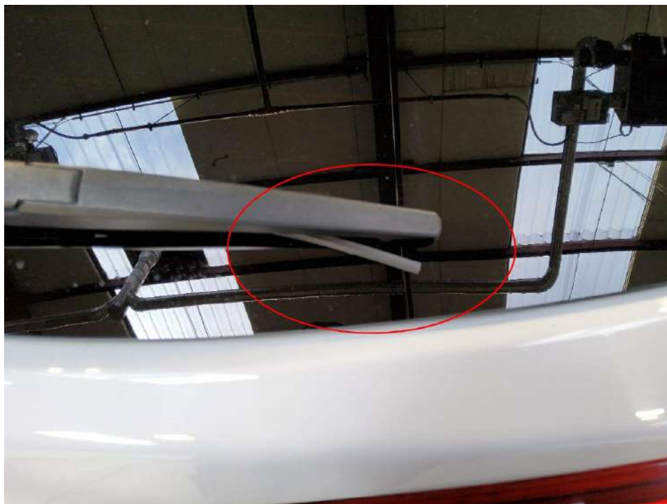
Bild 17 : Wischerblatt Heckklappe beschädigt
