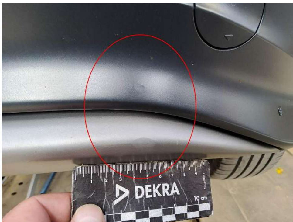
Bild 24 : Kunststoff Blende Stoßfänger hinten verschrammt
