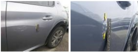
Aile ARG, Bosse(s), LI - Réparer et peindre (complet)
