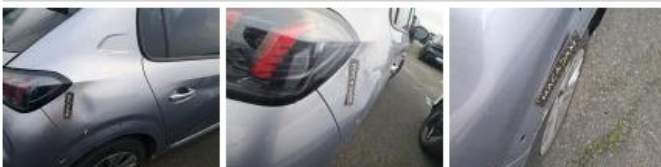
Porte AVD, Bosse(s), LI - Réparer et peindre (complet)
