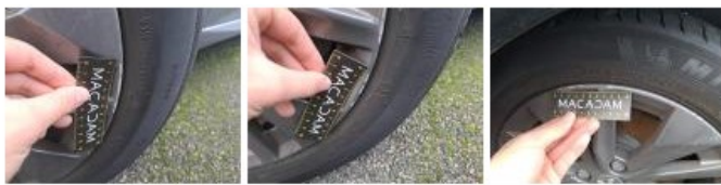
Pneu ARG, Déchirure, E - Remplacer
