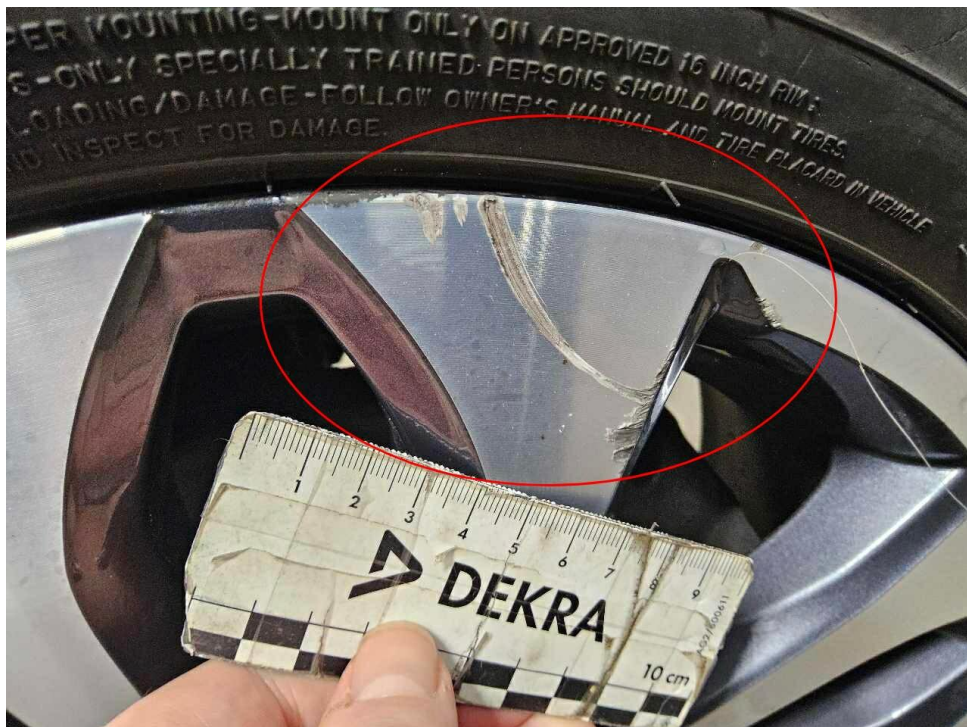
Bild 16 : Felge vorne rechts starker Materialabtrag
