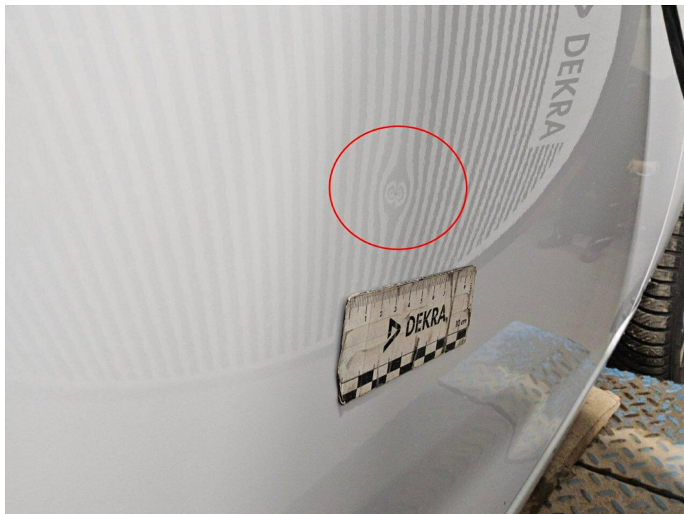
Bild 6 : Tür vorne rechts, eingedellt, smart repair
