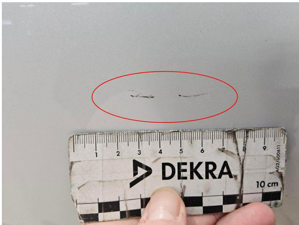
Bild 8 : Stoßfänger hinten, verschrammt, smart repair
