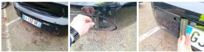
Capteur de parking AR, Manque, E - Remplacer
