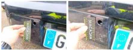
Capteur de parking AR, Manque, E - Remplacer
