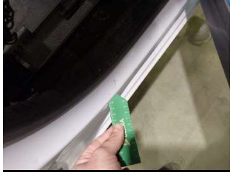
Door sill / Front Right / Dent
