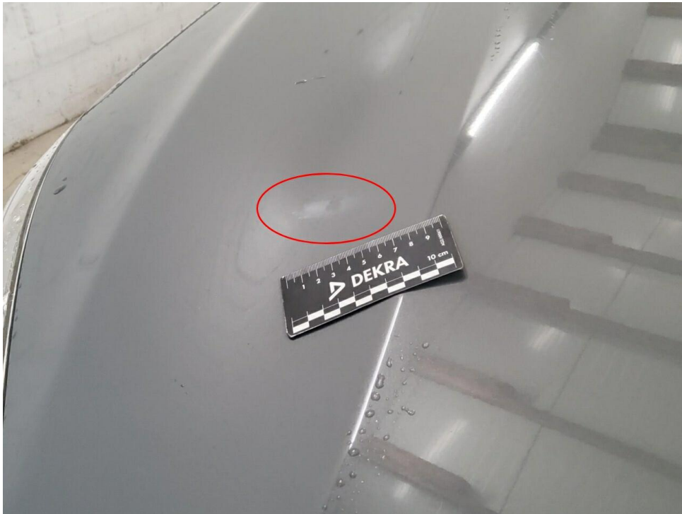
Bild 9 : Motorhaube Lackierung, verschrammt, smart repair
