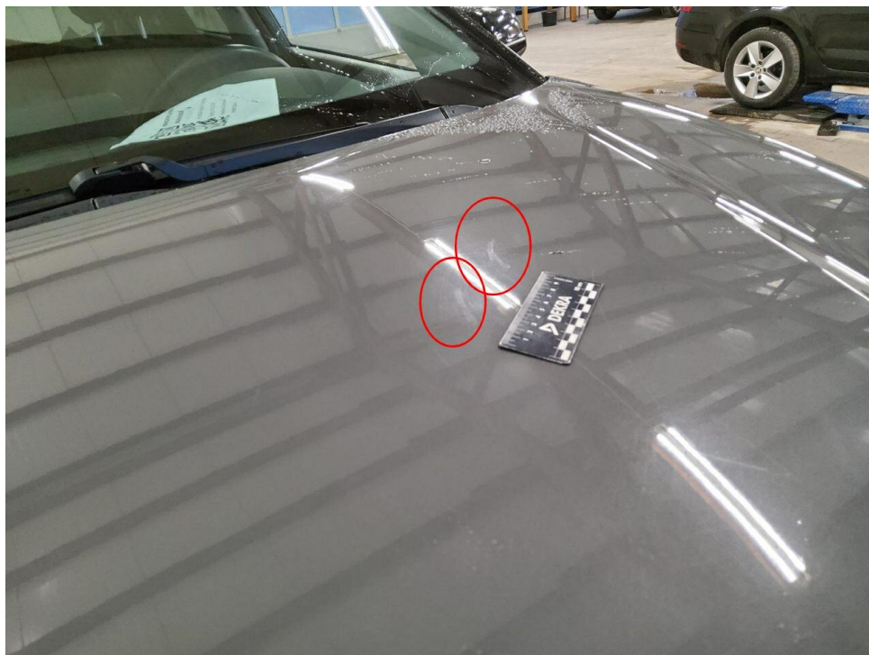
Bild 8 : Motorhaube Lackierung, verschrammt, smart repair
