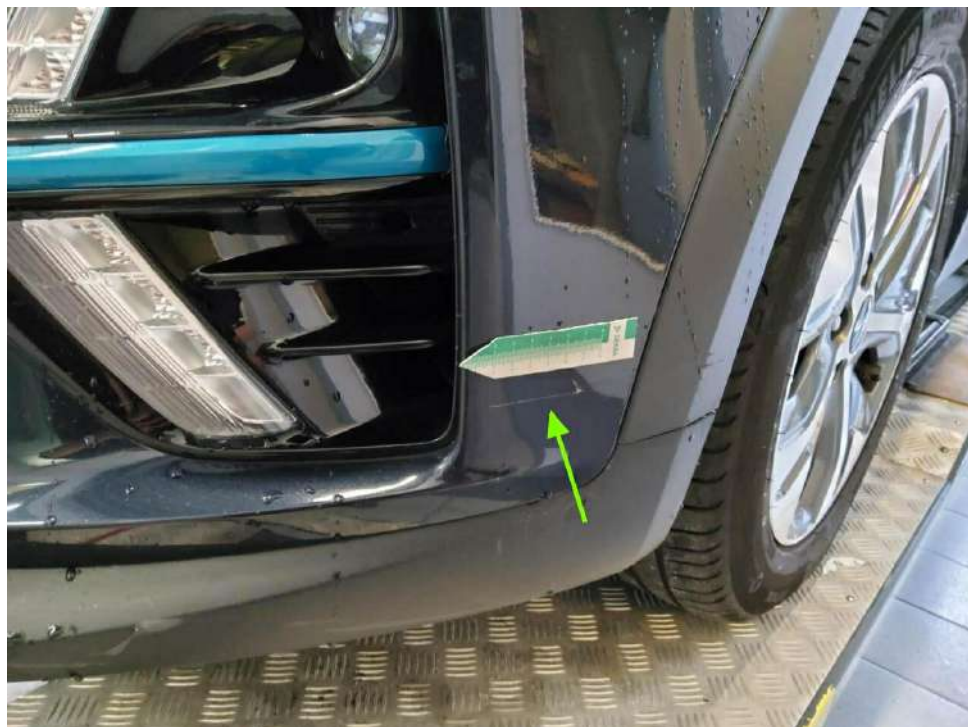
Bild 12 : Stoßfänger vorne Lackierung, zerkratzt, smart repair
