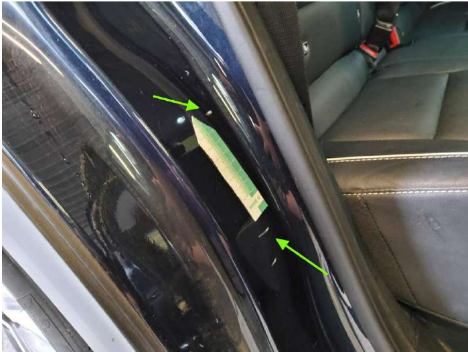
Bild 15 : Tür hinten rechts Einstieg, zerkratzt, lackieren mit Lackaufbau
