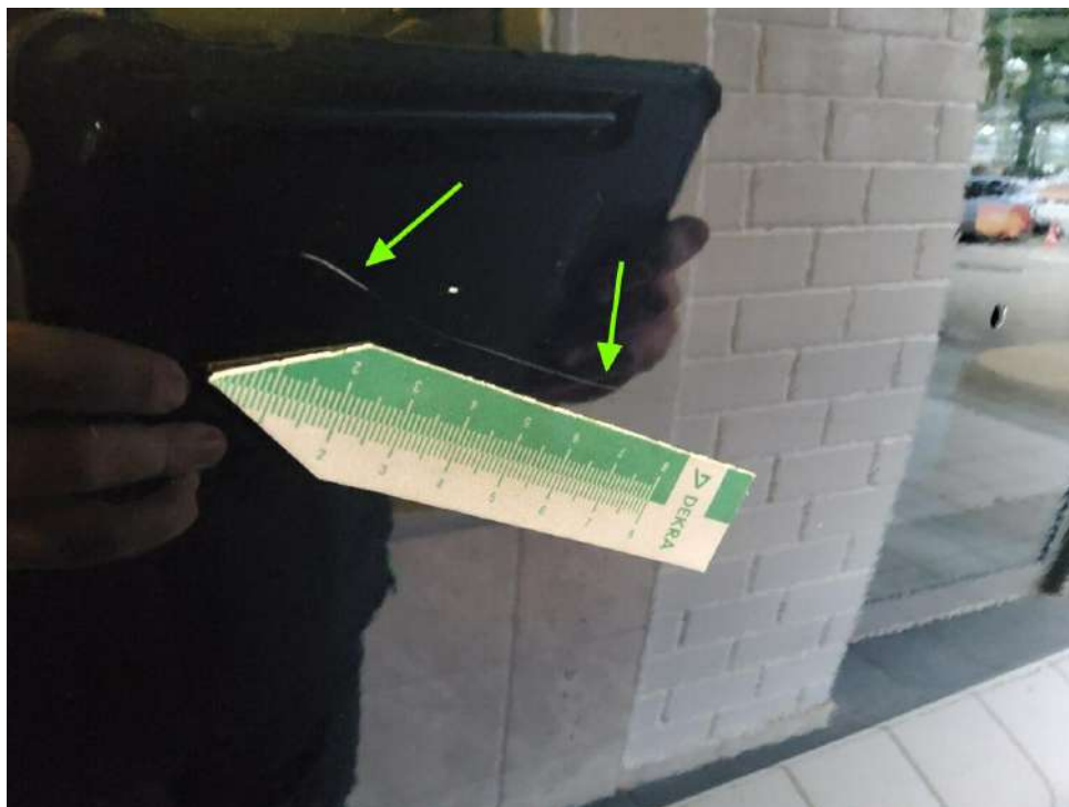
Bild 19 : Tür vorne links Lackierung, zerkratzt, lackieren mit Lackaufbau
