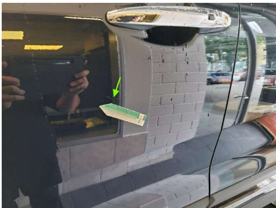
Bild 18 : Tür vorne links Lackierung, zerkratzt, lackieren mit Lackaufbau
