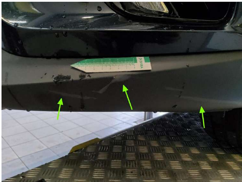
Bild 14 : Spoiler Stoßfänger vorne verschrammt
