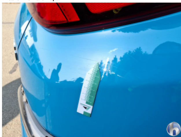
3. Seitenwand - Hinten - Rechts Oberflächenkratzer - Aufbereiten / Polieren
