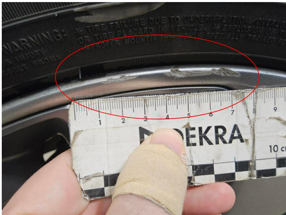
Bild 8 : Felge vorne links, verschrämmt, smart repair
