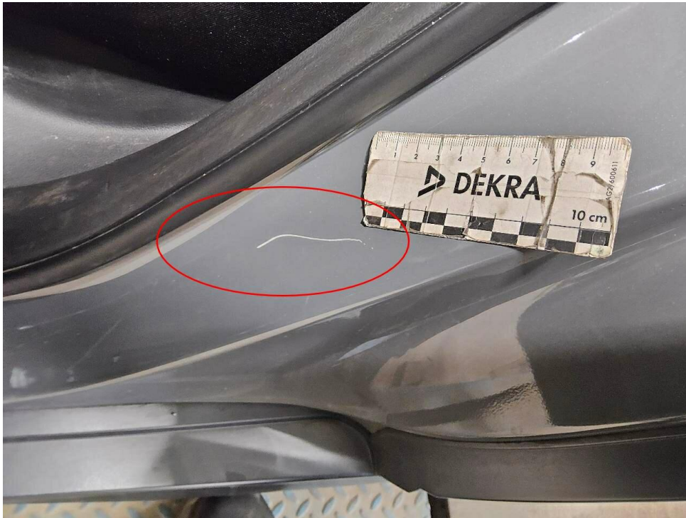
Bild 13 : Einstig hinten links verschrammt
