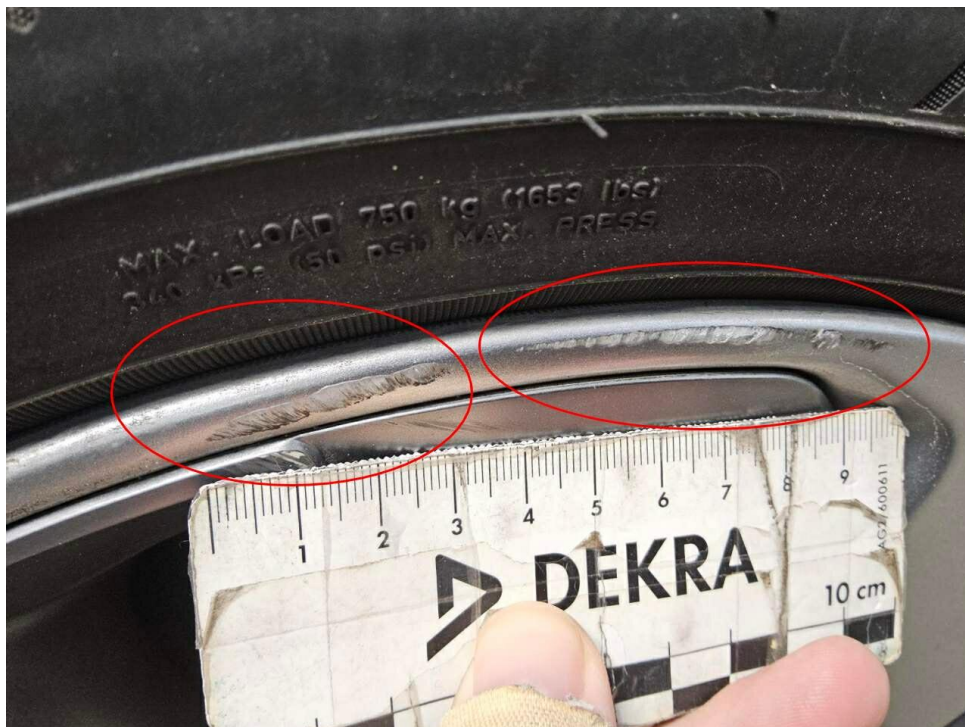
Bild 6 : Felge hinten links, verschrammt, smart repair
