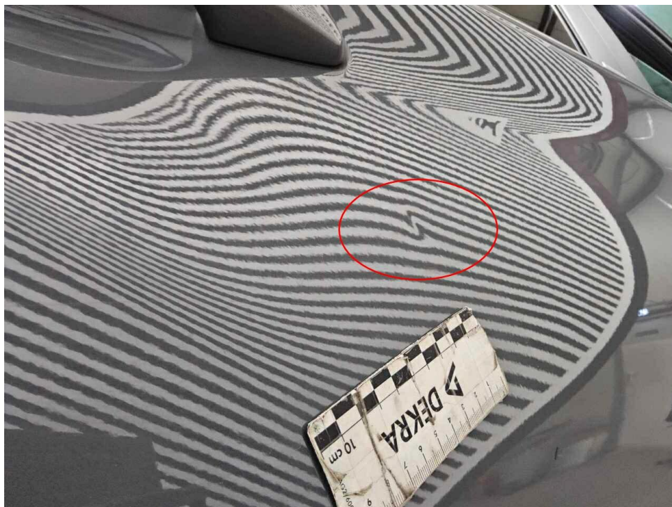
Bild 5 : Tür hinten rechts, eingedellt, smart repair
