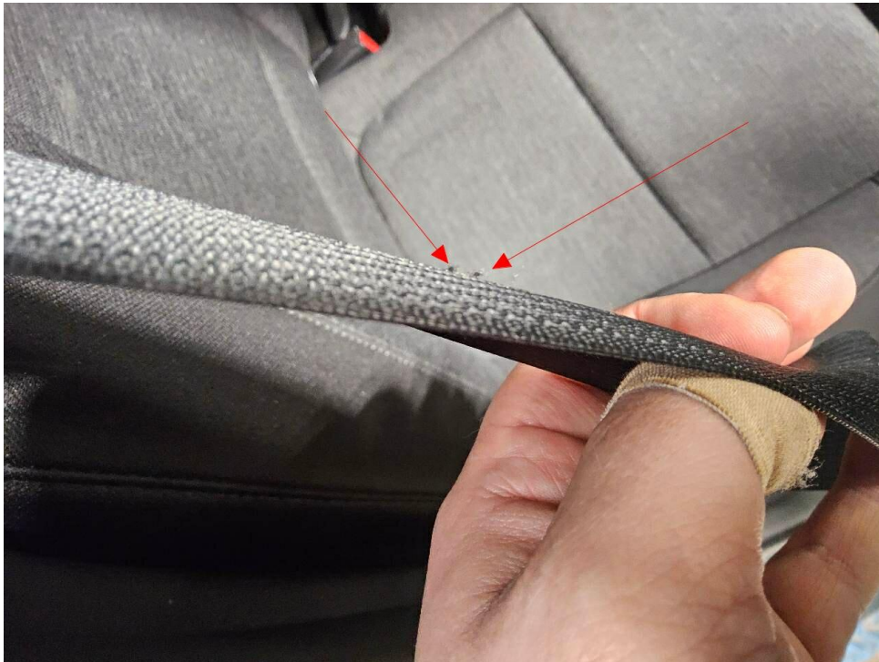
Bild 11 : Sicherheitsgurt hinten links und rechts beschädigt
