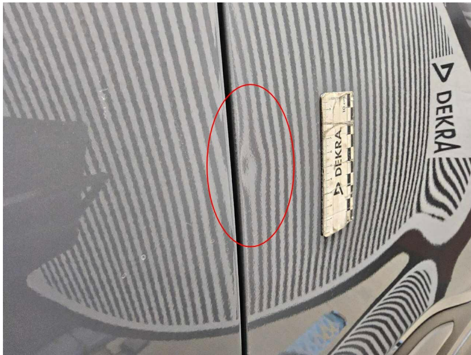
Bild 7 : Tür hinten links, eingedellt, smart repair
