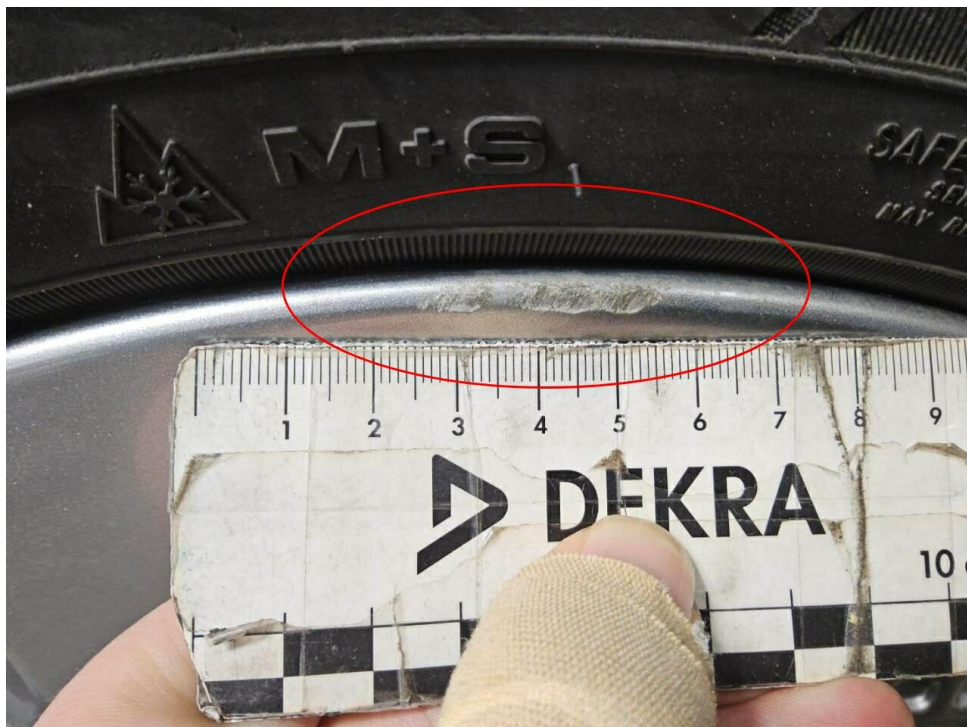
Bild 10 : Felge vorne rechts, verschrammt, smart repair
