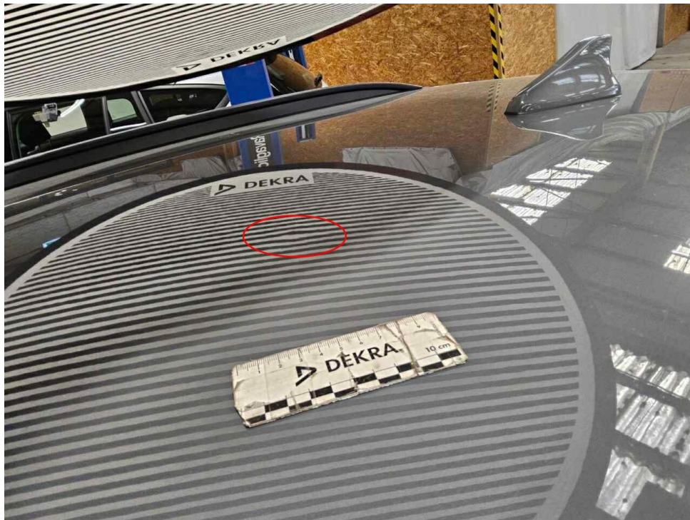
Bild 9 : Dach, eingedellt, smart repair
