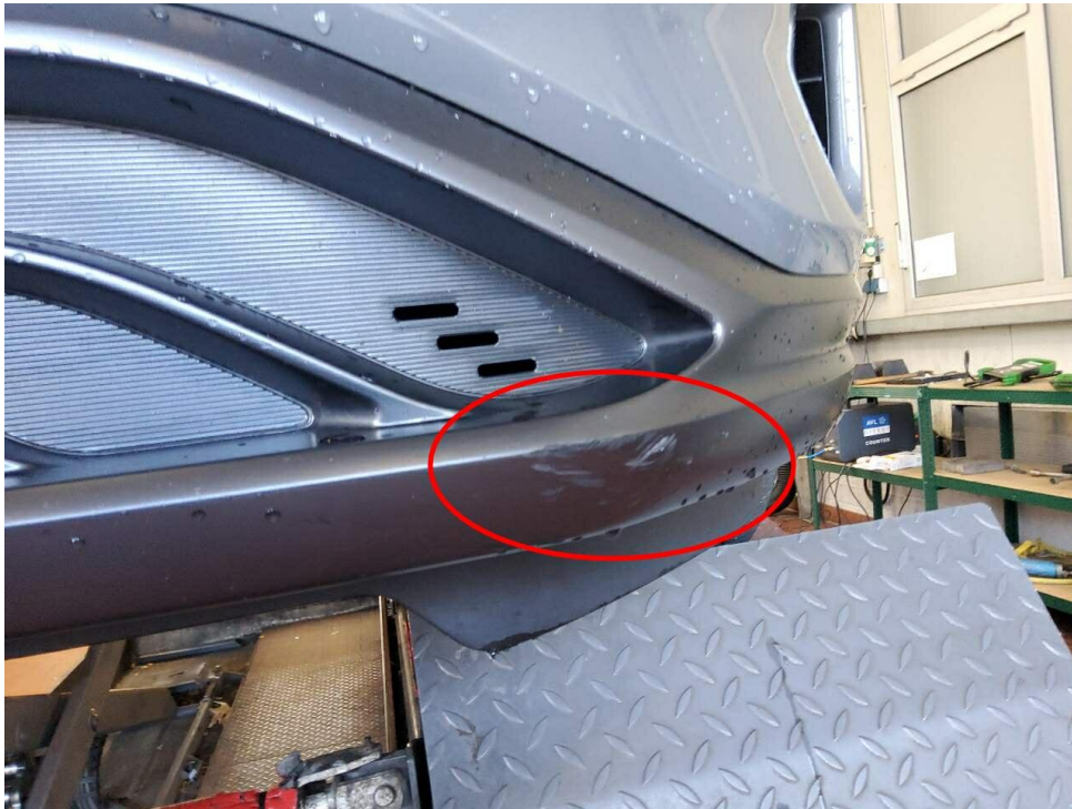
Bild 7 : Frontspoiler, zerkratzt, erneuern
