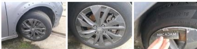
Jante alum. AVG, Griffe(s), E - Remplacer
