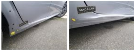
Porte ARD, Bosse(s) et griffe(s), LI - Réparer et peindre (complet)
