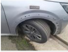
Aile AVD, Mauvaise réparation, Peindre
