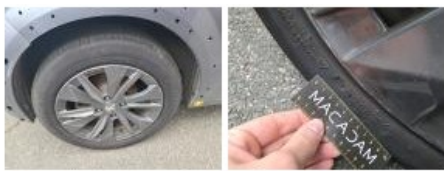
Jante alum. ARD, Griffe(s), E - Remplacer
