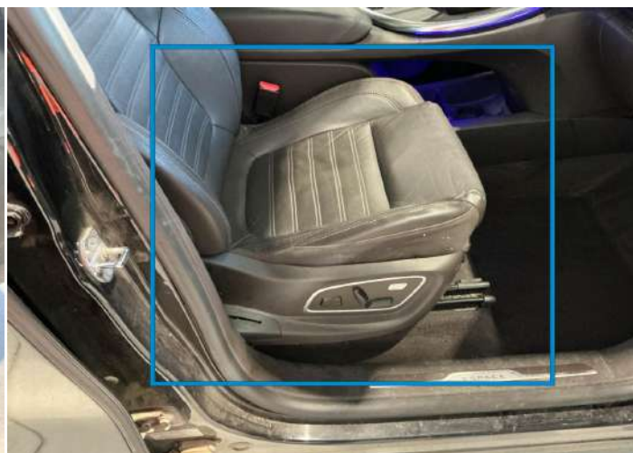
20. Revêtement assise Avant Droit Usé -
