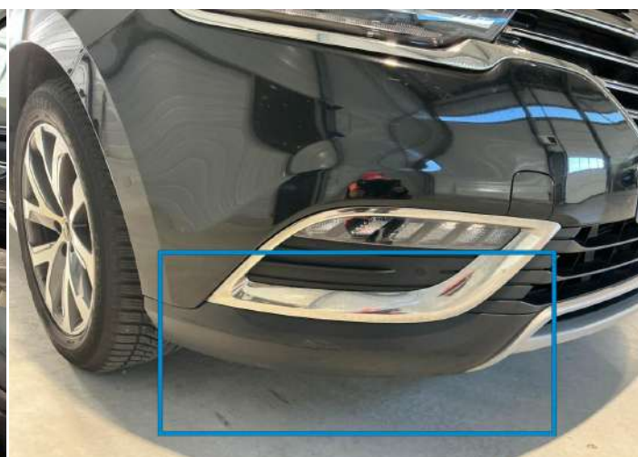
28. Coin de pare chocs Avant Droit Peinture Rayure Ligne -
