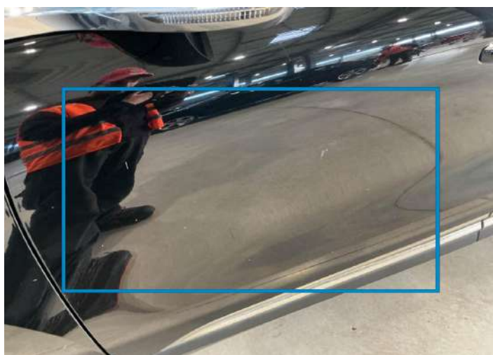
21. Porte Avant Gauche Peinture Rayure Ligne -
